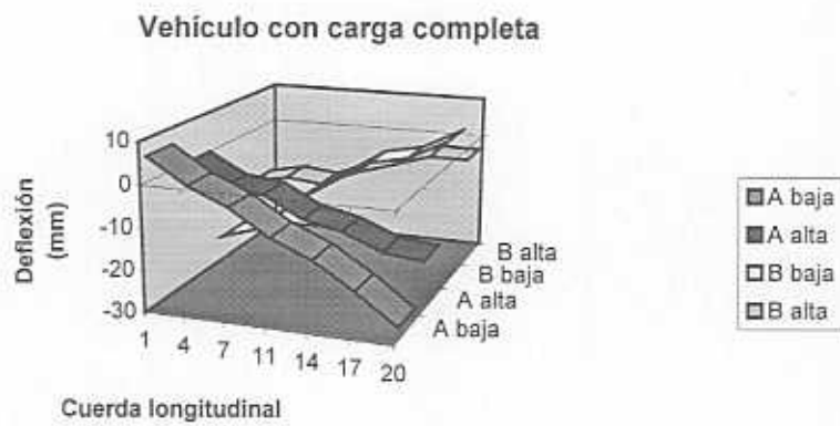
Figura 5.12 Flecha estática en el centro del claro
