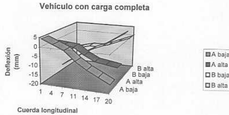
Figura 5.13 Flecha estática en el 3er cuarto Sur
