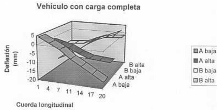
Figura 5.11 Flecha estática en el 1er cuarto Norte
