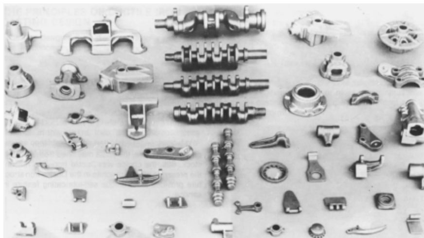
Figura 12 Algunas de las partes hechas con Hierro Nodular, utilizados en Automóviles Japoneses [18]
