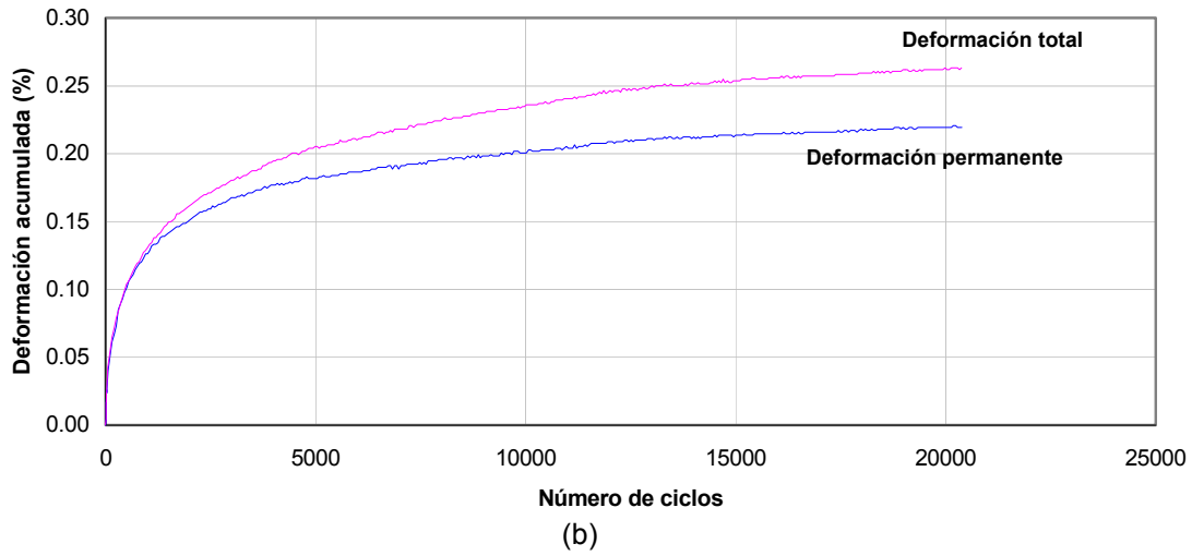
Figura 2-1 Deformación acumulada con el número de aplicaciones del esfuerzo desviador
