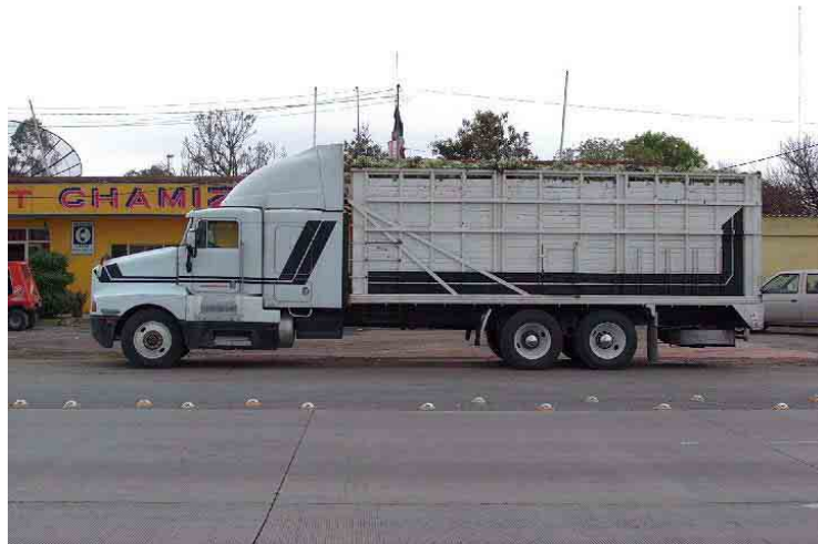
Figura 1-3 Configuración de vehículo C3 (eje delantero sencillo y traseros duales)
