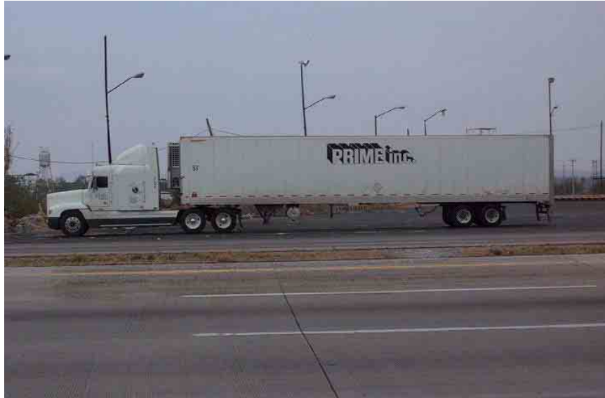
Figura 1-4 Configuración de vehículo T3-S2 (eje delantero sencillo y traseros duales en el tractocamión y ejes duales en el semiremolque)
