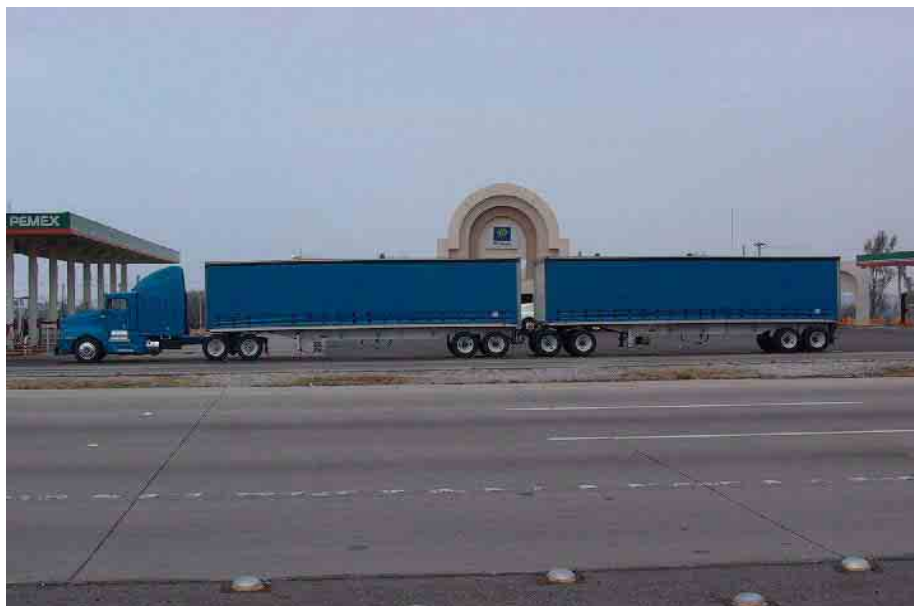
Figura 1-6 Configuración de vehículo T3-S2-R4 (eje delantero sencillo y traseros duales en el tractocamión, ejes duales en el semiremolque y remolque)
