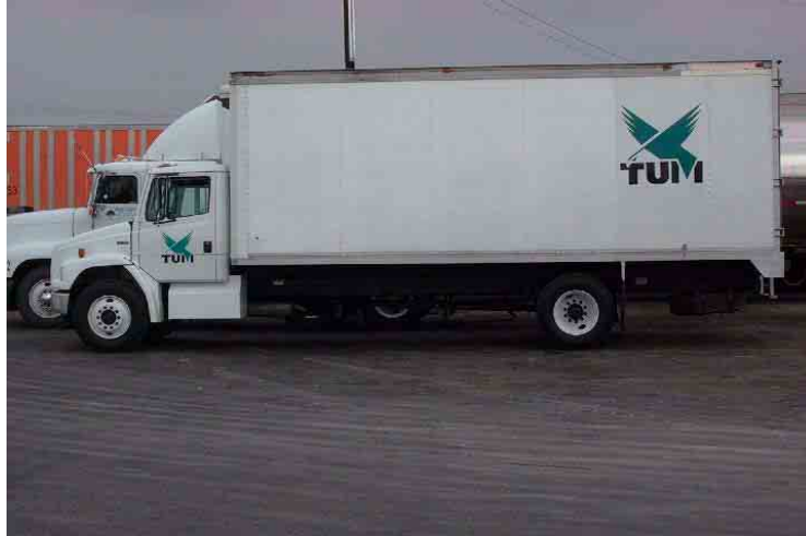
Figura 1-2 Configuración de vehículo C2 (eje delantero sencillo y trasero dual)
