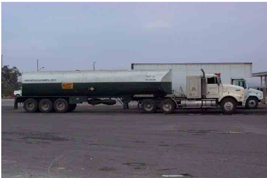
Figura 1-5 Configuración de vehículo T3-S3 (eje delantero sencillo y traseros duales en el tractocamión y ejes duales en el semiremolque)
