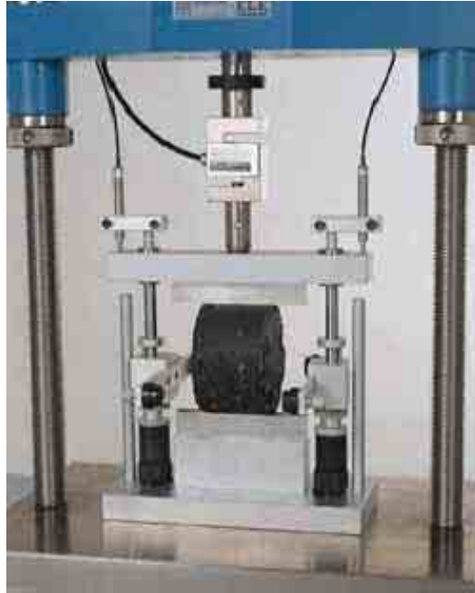
Figura 5-12 Prueba de fatiga por compresión
