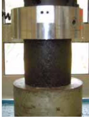
Figura 5.16 Ensayo de inmersión-compresión
