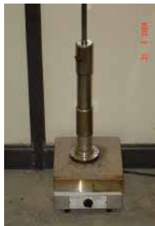
Figura 5.11 Plancha y pisón de compactación
