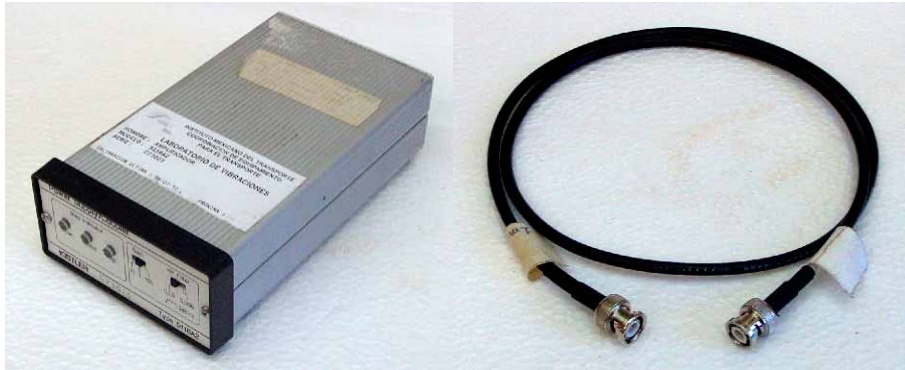
Figura 4.10 Fuente acondicionadora KISTLER, [21], y cable con terminales BNC.
