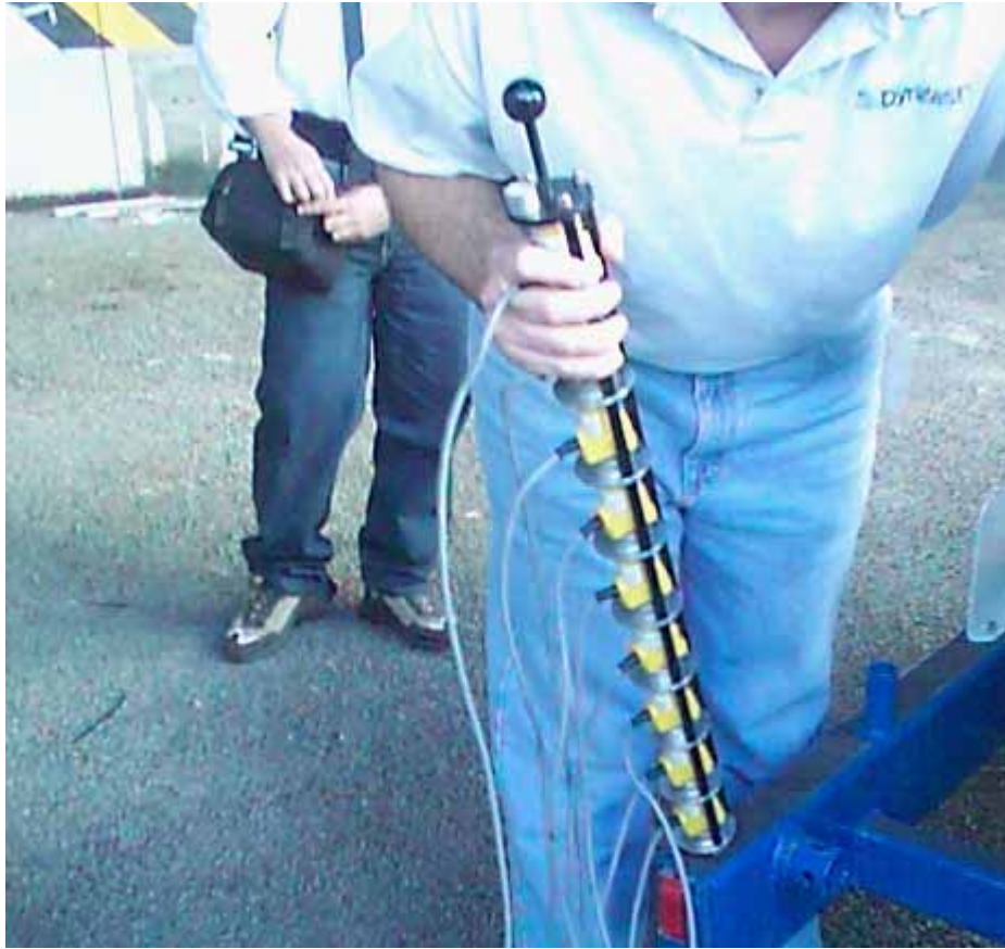
Figura 3.1. Barra de sujeción para transductores de deflexión; se observa la colocación de los transductores en la barra
