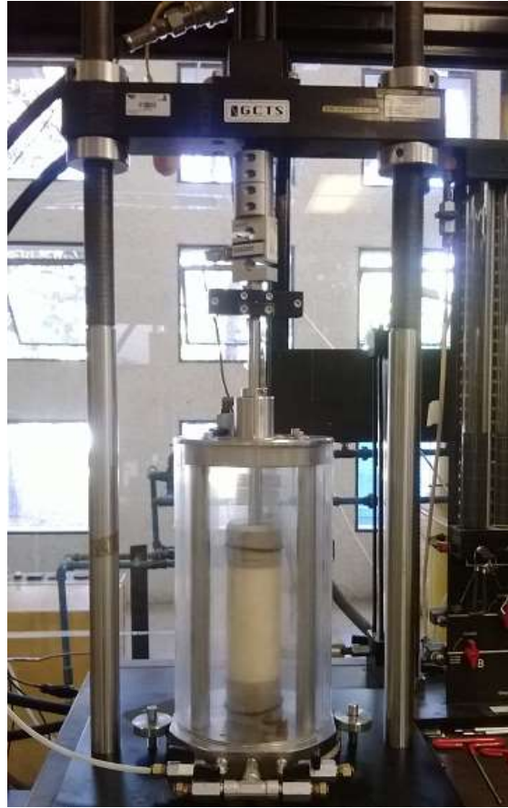
Figura 3.7. Muestra EPS geofoam en equipo triaxial
