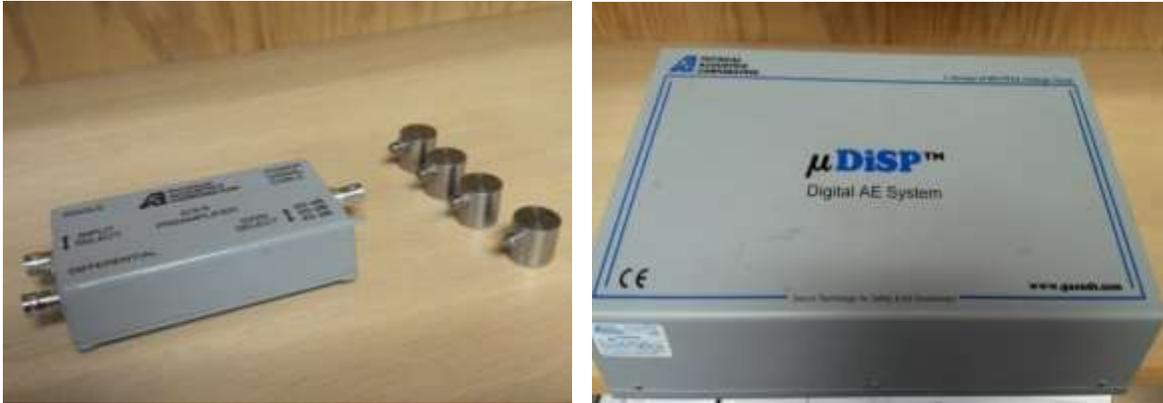
Figura 2.1 Equipo de medición de emisión acústica
