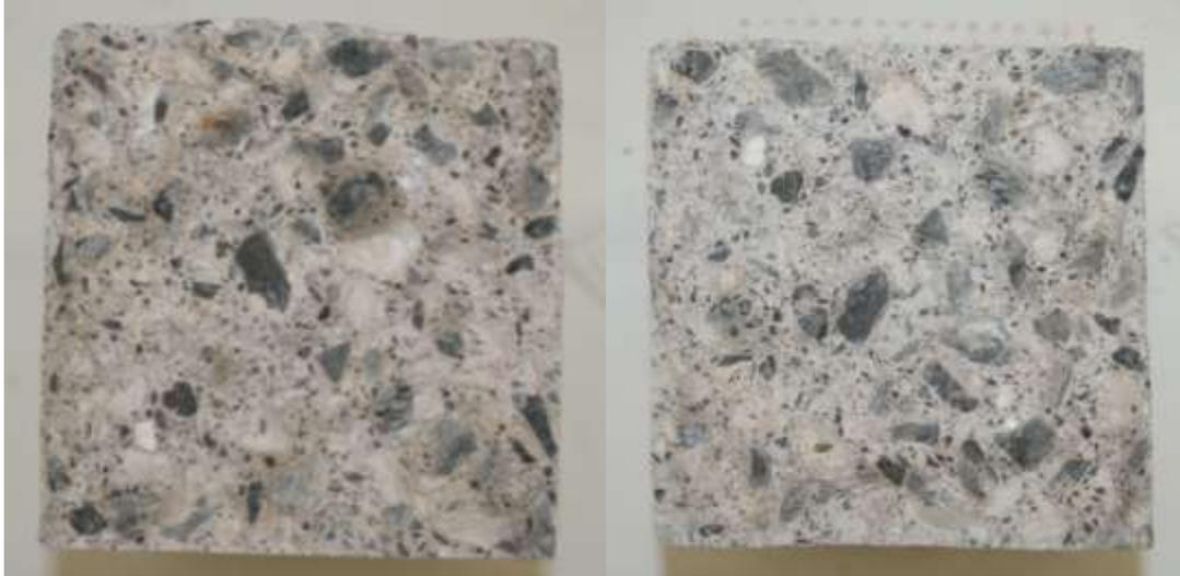
**Figura 3.10 Imagen de superficies de fractura sin procesamiento**
