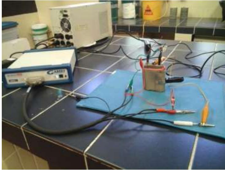
**Figura 15. Esquema de conexión de la celda electroquímica**
