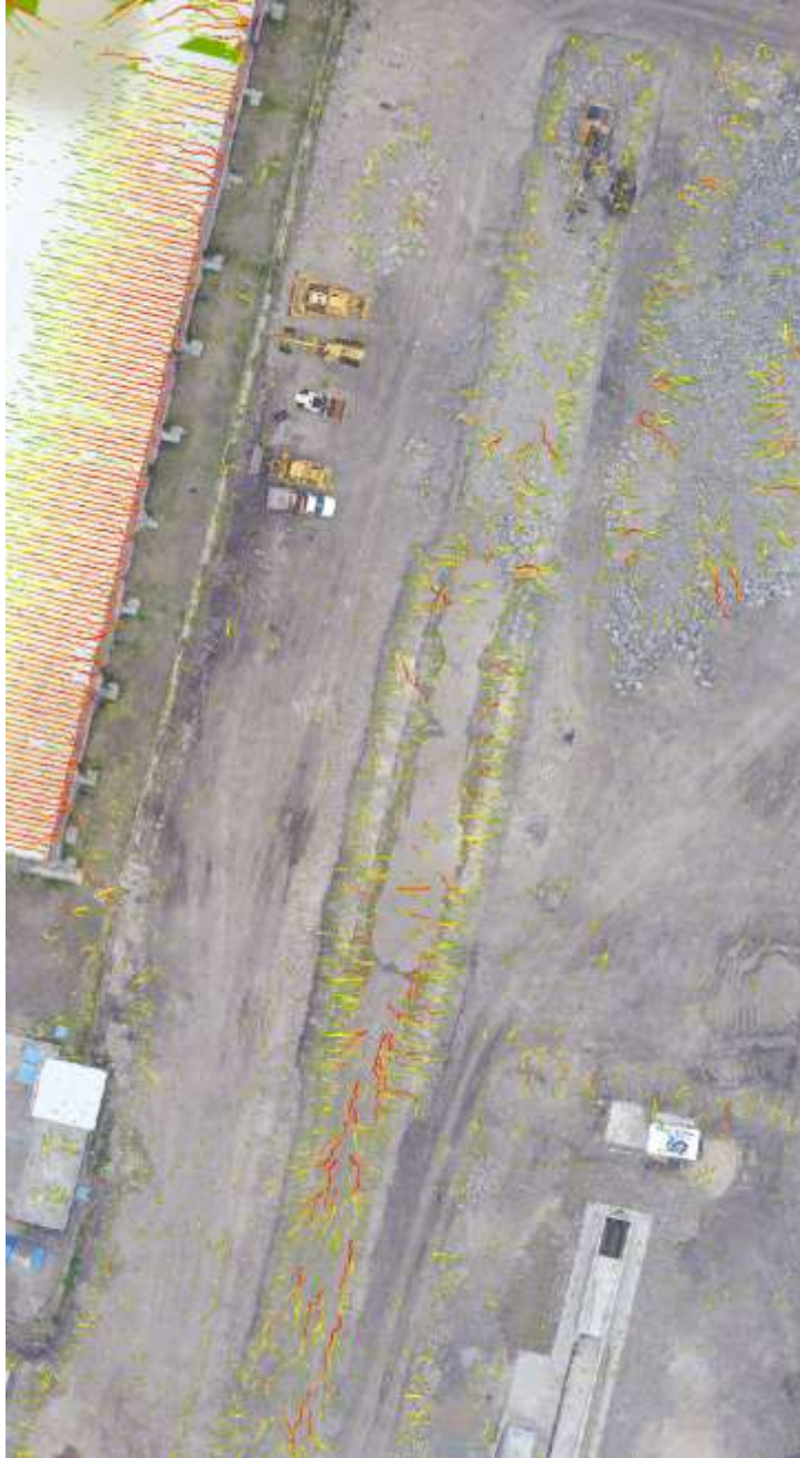
Figura 3.43. Se muestran direcciones y grado de acumulación de flujo de agua. Los tonos rojos indican el mayor acumulación.
