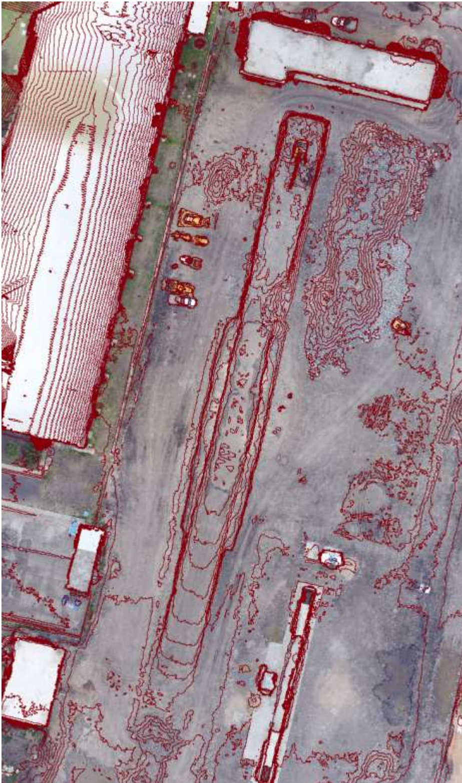
Figura 3.42. Curvas de nivel generadas a partir del Modelo Digital de Elevación.
