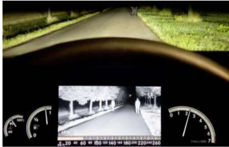
Figura 3.2 Pantalla de imágenes térmicas del sistema de visión nocturna
