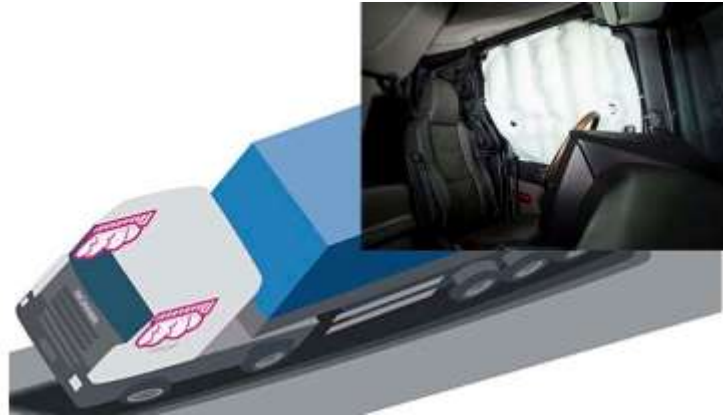
Figura 3.9 Bolsa de aire lateral para proteger al conductor
