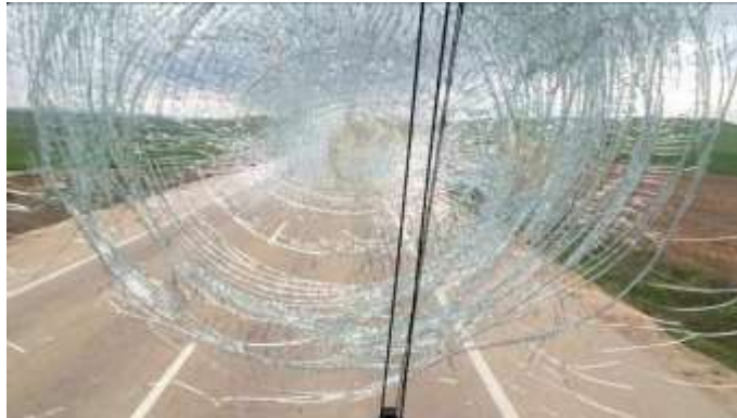
Figura 3.13 Parabrisas laminado de un autobús estrellado
