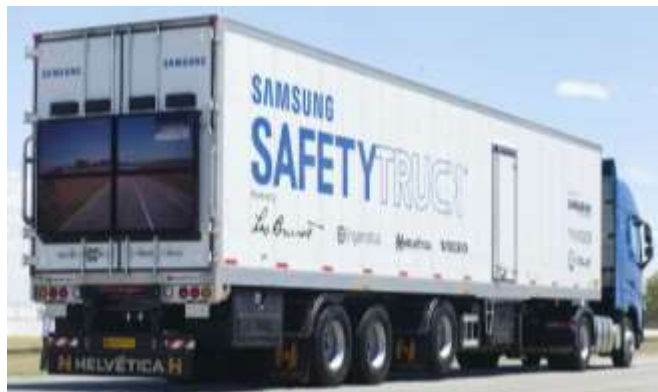
Figuras 3.17 y 3.18 Sistema de cámara delantera y pantalla gigante en la parte trasera para realizar maniobras de rebase de un vehículo de carga
