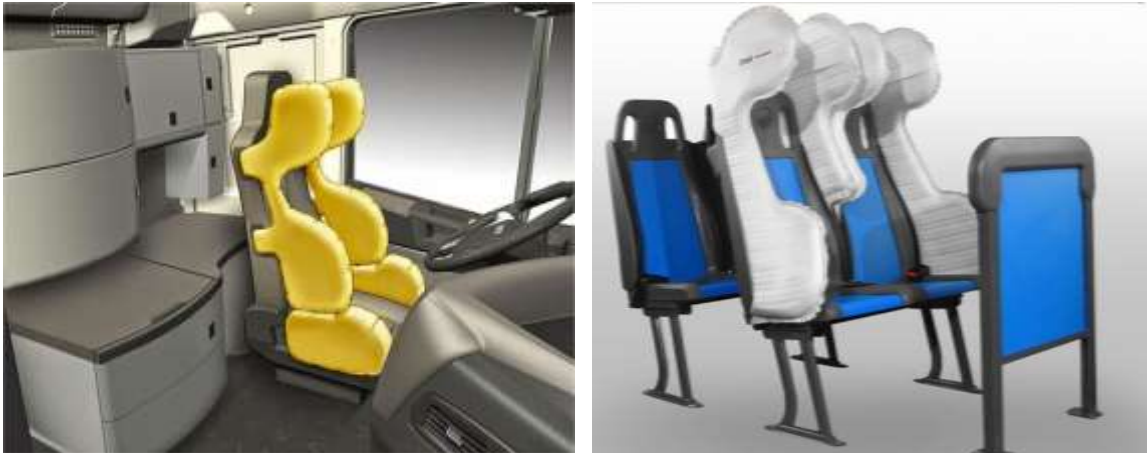
Figura 3.27 y 3.28 Bolsas de aire con estructura 3D integrado a los asientos del conductor o pasajeros
