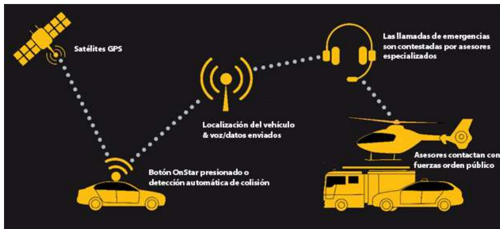
Figura 3.4 Esquema de funcionamiento de la llamada automática de emergencia
