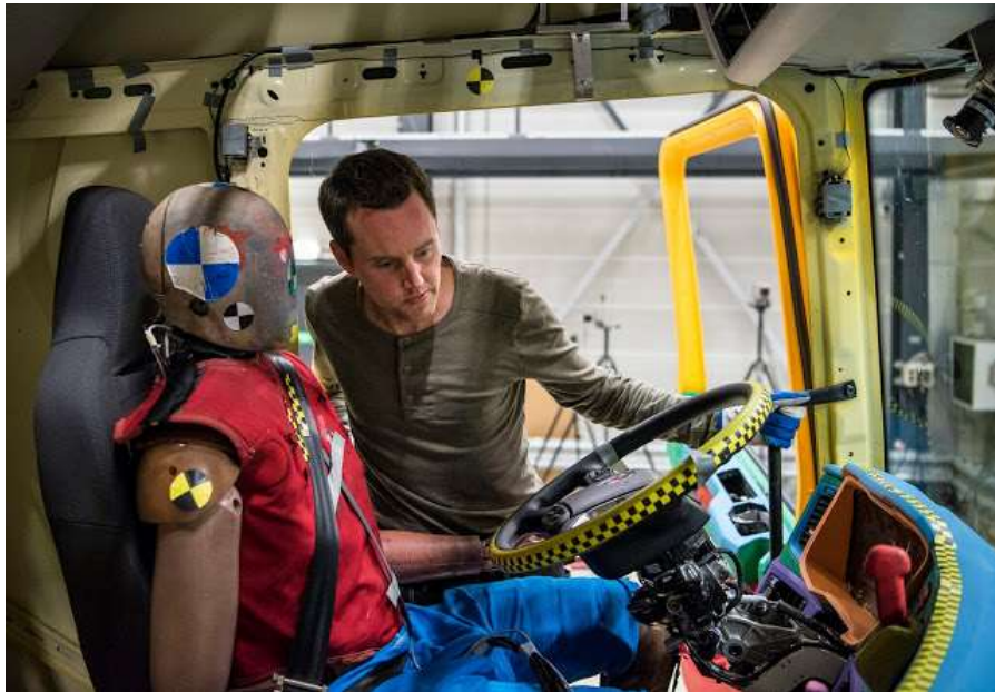
Figura 3.26 Prototipo de una cabina más resistente para una mayor seguridad al conductor, previo a someterse a impactos
