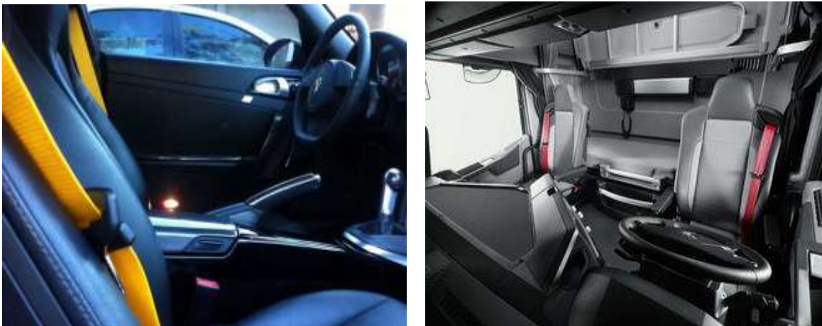
Figuras 3.7 y 3.8 Cinturones de seguridad de color diferente para distinguir si lo tienen puesto conductor y pasajeros
