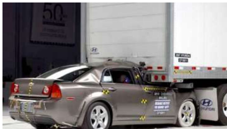
Figura 3.12 Prueba de ensayo de protecciones traseras colapsables en vehículos de carga
