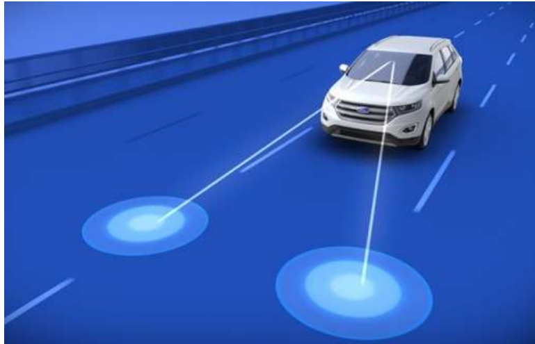
Figura 3.5 Esquema de funcionamiento de asistencia de cambio de carril
