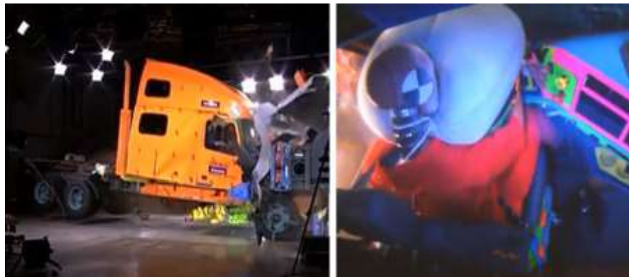
Figura 3.16 Pruebas de impacto en chasis para deformarse progresivamente
