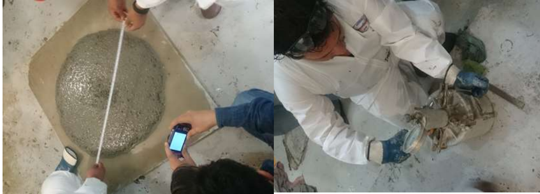
Figura 2.1 Obtención de extensibilidad (izquierda) y contenido de aire (derecha)
