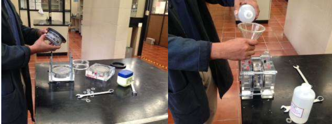
Figura 2.5 Montaje de rodaja en celda de prueba y vaciado de soluciones
