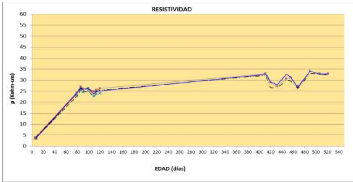
Figura 3.4 Resultados de las pruebas de REH para M1 de Aditivo 3
