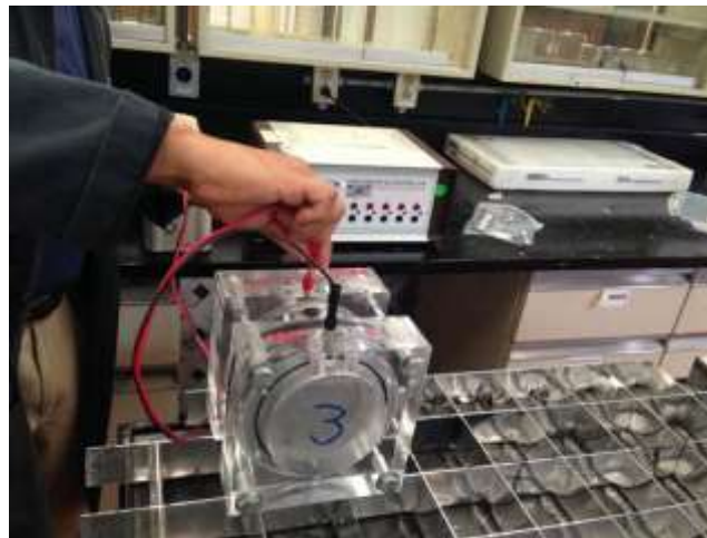
Figura 2.6 Conexión de celda a unidad de control
