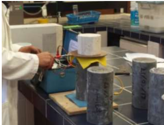
Figura 2.2 Medición de la REH en cilindros de concreto
