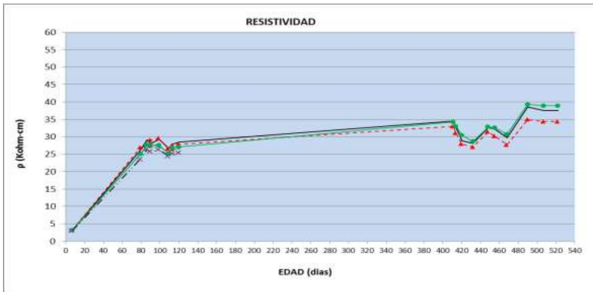
Figura 3.4 Resultados de las pruebas de REH para M1 de Aditivo 3
