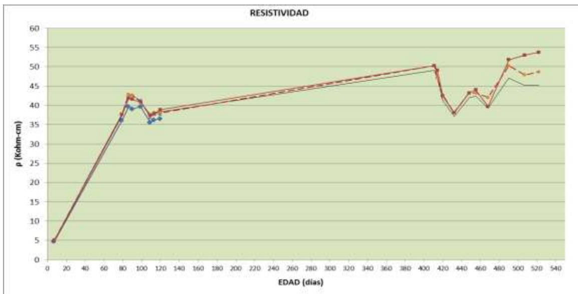
Figura 3.6 Resultados de las pruebas de REH para M3 de Aditivo 3
