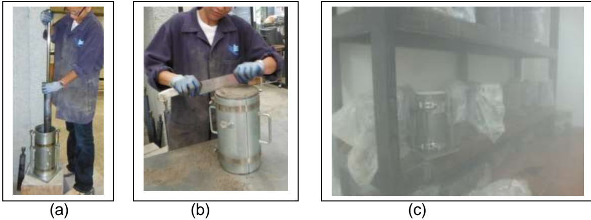
Figura 3.9. (a) Compactación en molde; (b) Enrase de la superficie de la muestra y; (c) Muestra colocada en el cuarto de curado.
