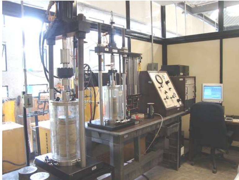
Figura 3.7. Muestra de agregado de concreto reciclado colocada en equipo triaxial.
