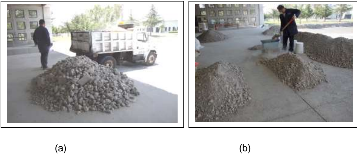
Figura 3.3. (a) Material retenido en la malla de una pulgada; (b) Cuarteo del material a tamaño de 50 kg aproximadamente
