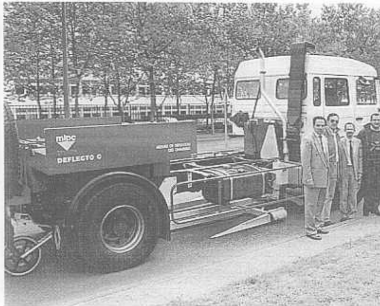
Figura 2.2 Equipo Automatizado para Medir Deflexiones Desarrollado en Francia (Deflectógrafo de Lacroix).
