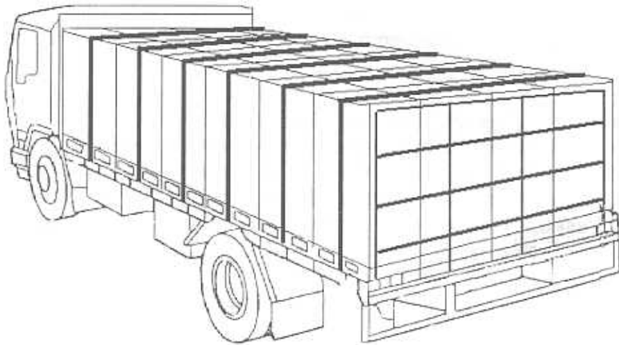
Figura 39. Amarres que empujan hacia abajo a cada tarima, en un camión totalmente cargado.
