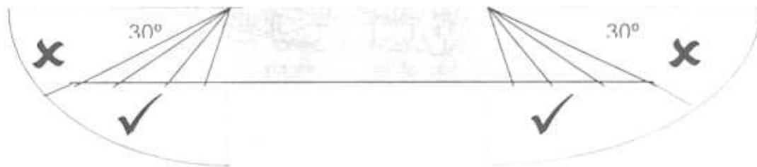
Figura 12. Ángulos recomendados para los sujetadores o amarres.
