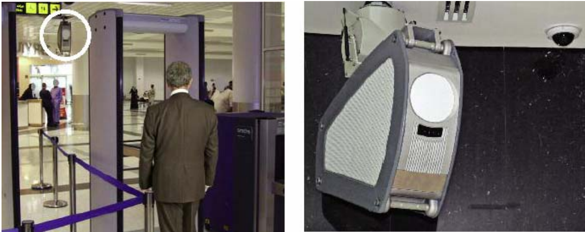
Figura 6.10 Instalación típica de un equipo T4000 Fuente: http://www.thruvision.com/
