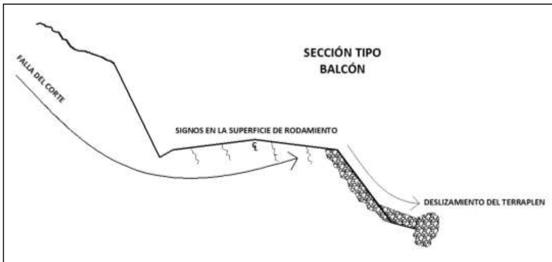
**Figura 4.3.** Deslizamiento. Sección tipo balcón
