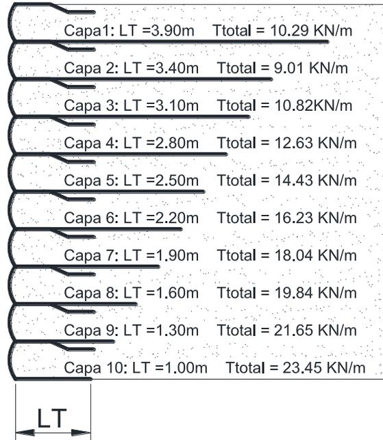
Como podemos observar, las longitudes totales encontradas no son uniformes, de tal manera que la longitud de refuerzo dada al inicio del ejemplo puede ser utilizada puesto que es mayor a las longitudes encontradas con el análisis de estabilidad interna; sin embargo, se necesita cumplir con la estabilidad externa por lo que se requiere mantener la longitud de refuerzo inicial, el análisis anterior da lugar a que la estabilidad interna del muro cumpla.
