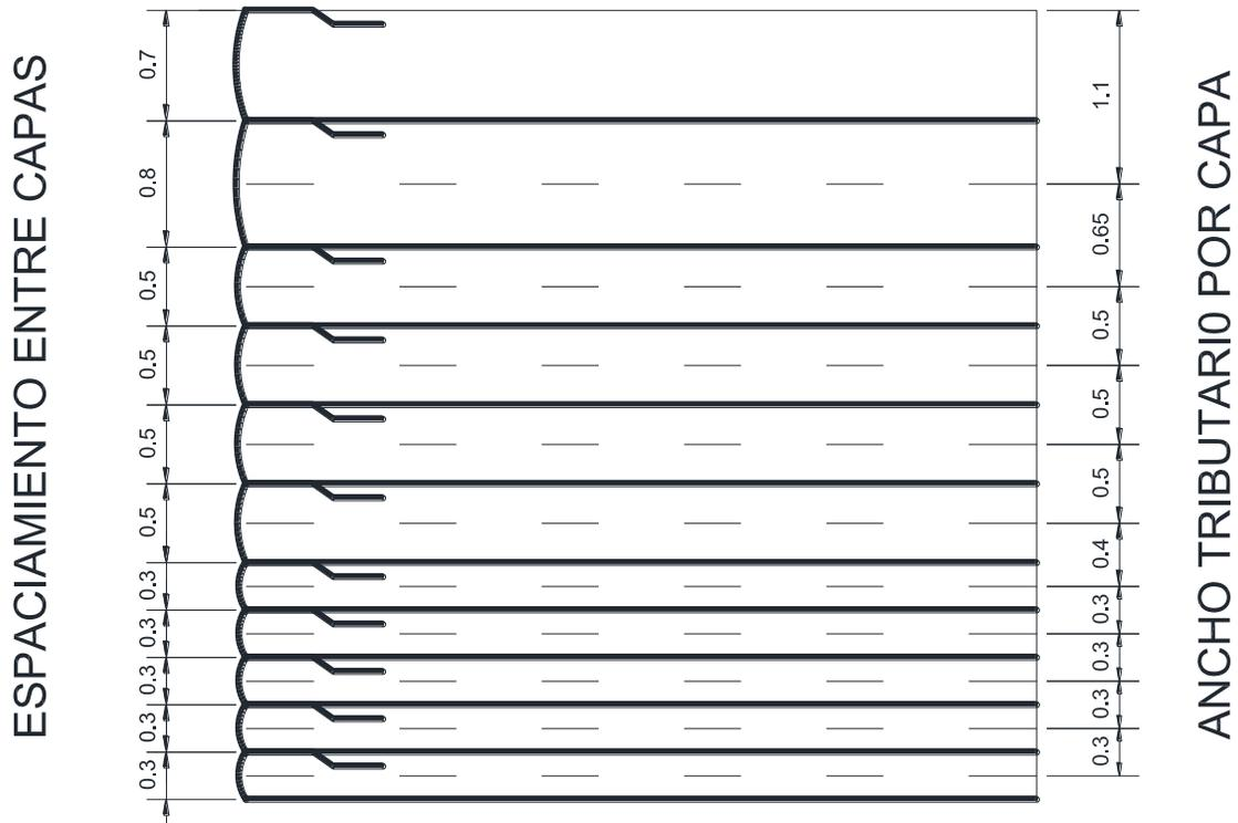
**Figura 30. Propuesta de espaciamiento entre capas de geosintético.**
