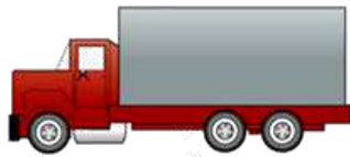
Camión unitario "Torthón" (C3)
