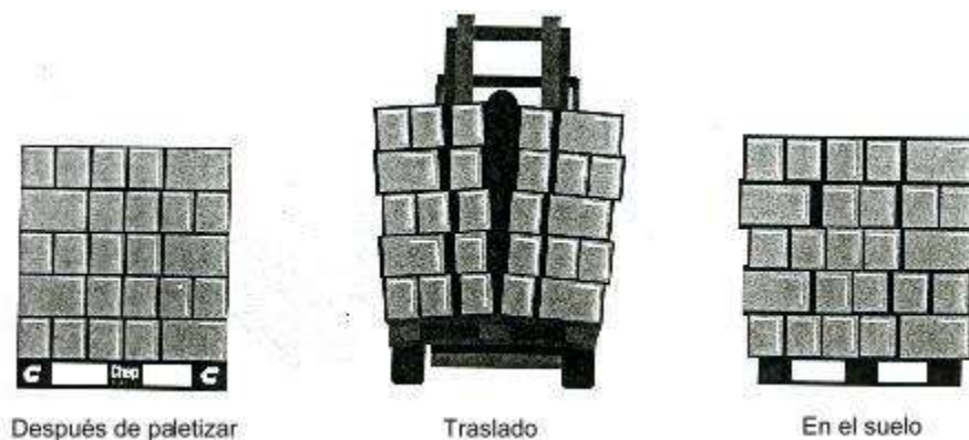
Figura 3.2. Proceso de deformación de la estiba durante su transferencia
