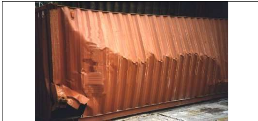
Figura 3.20 Daño al contenedor por una mala sujeción de la carga
