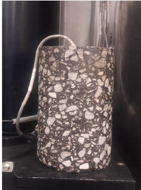
Figura 4. Especimen con termocople para monitorear la temperatura del espécimen de ensayo.
