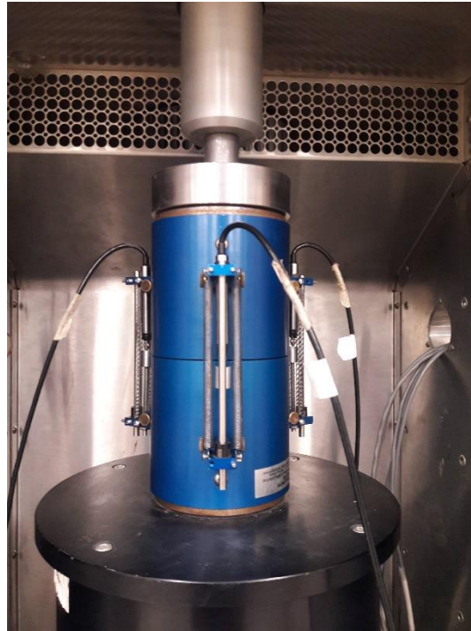
Figura 2.2 Probeta patrón para verificar el funcionamiento del equipo de ensayo.
