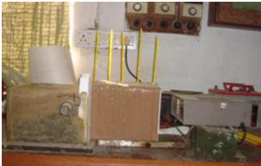
Figura 1.6. Experimento para obtención de perfil de temperatura
