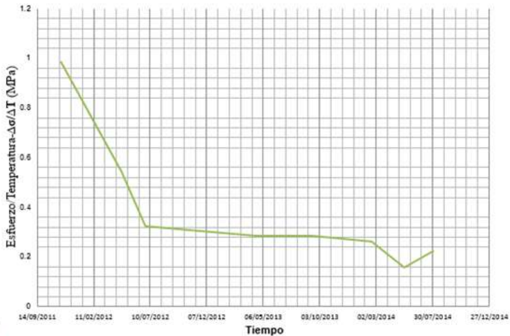
Figura 1.12 Esfuerzo/°C, en sensor colocado en concreto en dirección longitudinal sobre la base hidráulica
