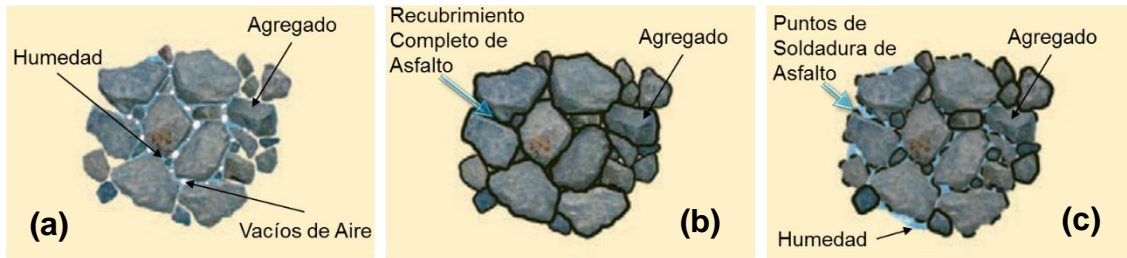
Figura 1.4 Material granular (a) no unido, (b) unión continua, (c) unión discontinua
