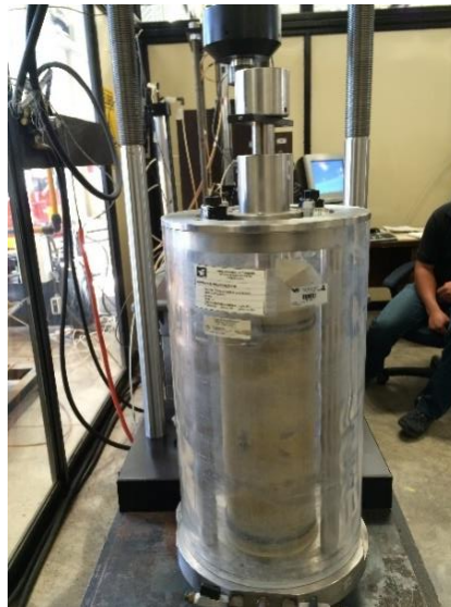
Figura 2.43 Colocación de cámara de acrílico
