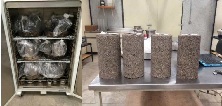
Figura 2.35 Proceso de curado de los especímenes
