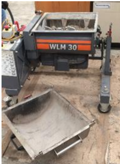
Figura 2.18 Equipo mezclador de doble eje Wirtgen WLM-30
