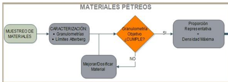
Figura 2. 6 Diagrama de flujo para materiales pétreos
