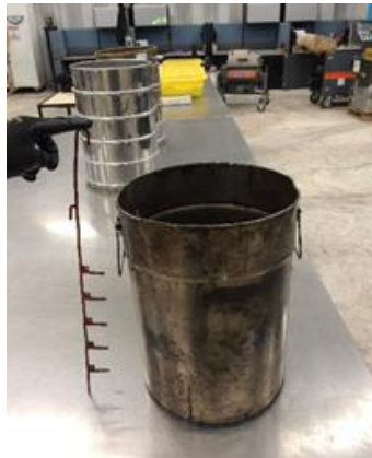
Figura 2.13 Recipiente y varilla estandarizada para medir la expansión del asfalto espumado
