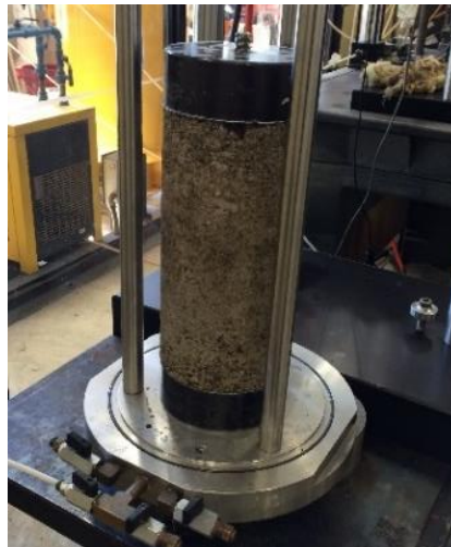
Figura 2.41 Colocación de probeta sobre la piedra porosa
