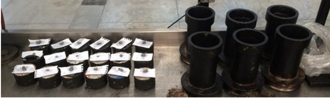
Figura 2.20 Especímenes nivel I compactados mediante el compactador giratorio
