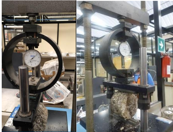
Figura 2.24 Ensayo de pruebas ITS
