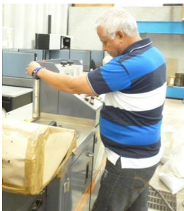
Figura 2.15 Ajuste del fluxómetro en el equipo WLB-30S
