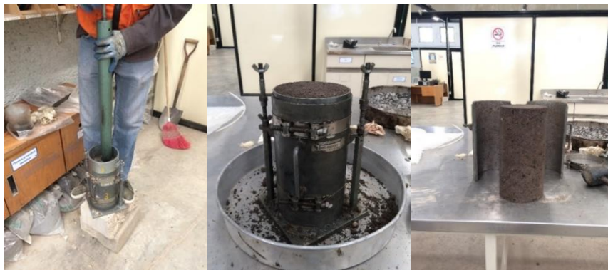
Figura 2.33 Compactación, enrasado y desacoplamiento del molde
