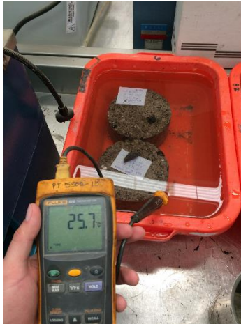
Figura 2.22 Especímenes ITS SATURADO
