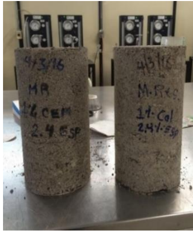
Figura 2.46 Especímenes ensayados para obtención de M_R
