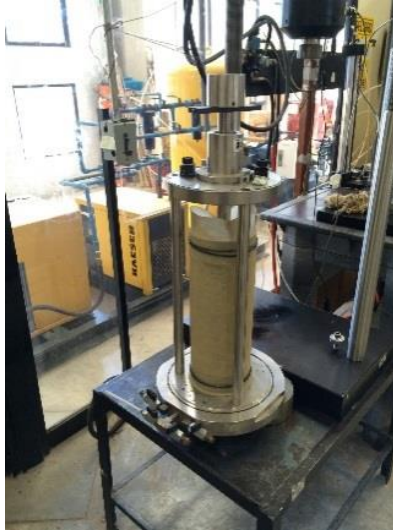
Figura 2.42 Colocación de membrana de látex
