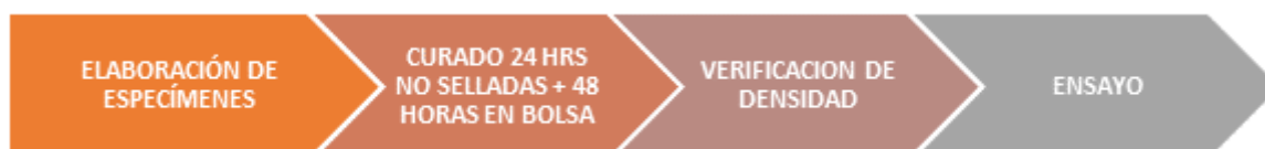
Figura 2.30 Procedimiento de acondicionamiento para ensayo de especímenes nivel III
