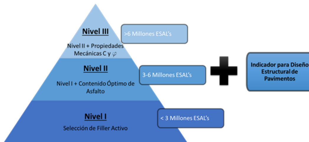
Figura 2.16 Propuesta de los diferentes niveles de diseño para una base estabilizada con asfalto espumado en México
