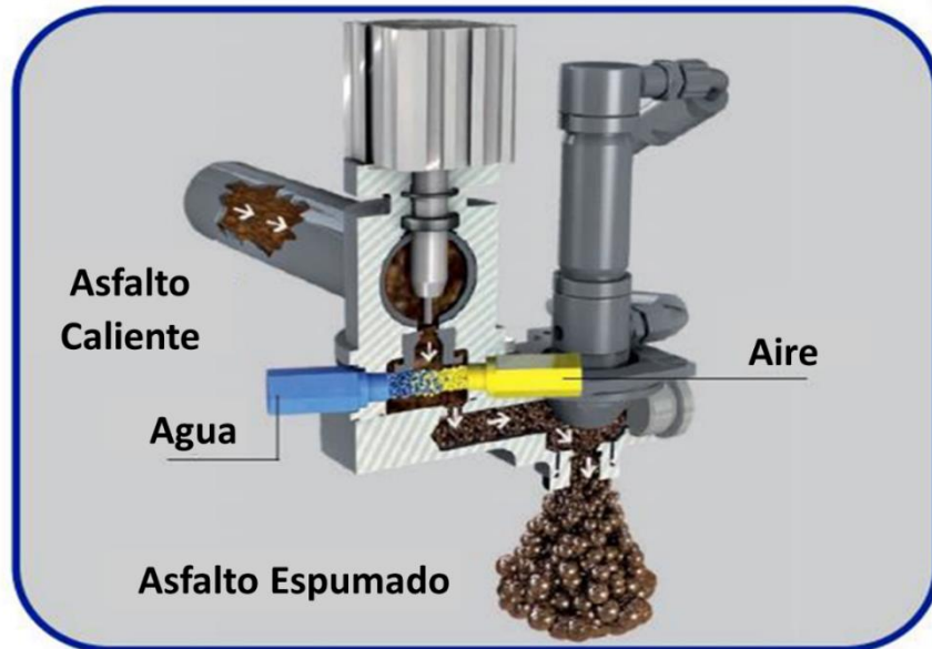
Figura 1.2 Cámara de expansión para asfalto espumado
