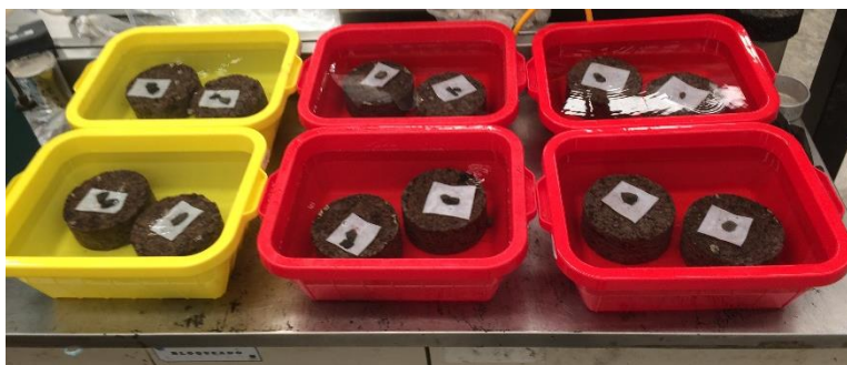
Figura 2.27 Proceso de acondicionamiento ITS EQUI-SAT
