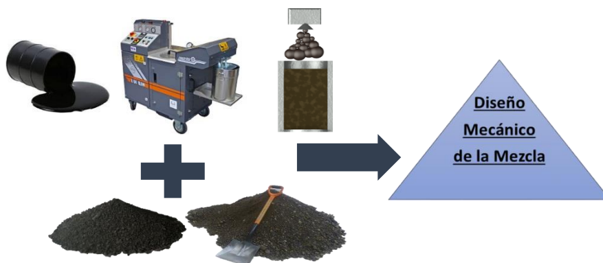
Figura 2.1 Elementos fundamentales para el diseño de na base estabilizada con asfalto espumado
