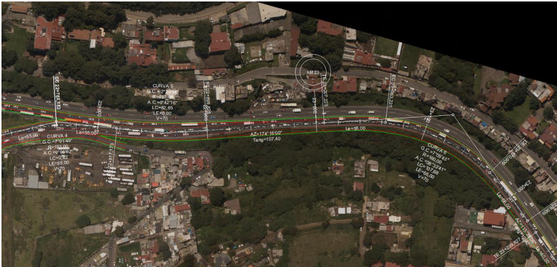
Figura 3.4. Reconstrucción de geometría a partir escaneo con vuelo LIDAR
