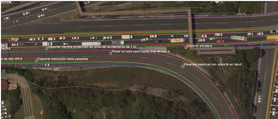
Figura 3.3. Discontinuidad de puente peatonal detectado desde una vista aérea
