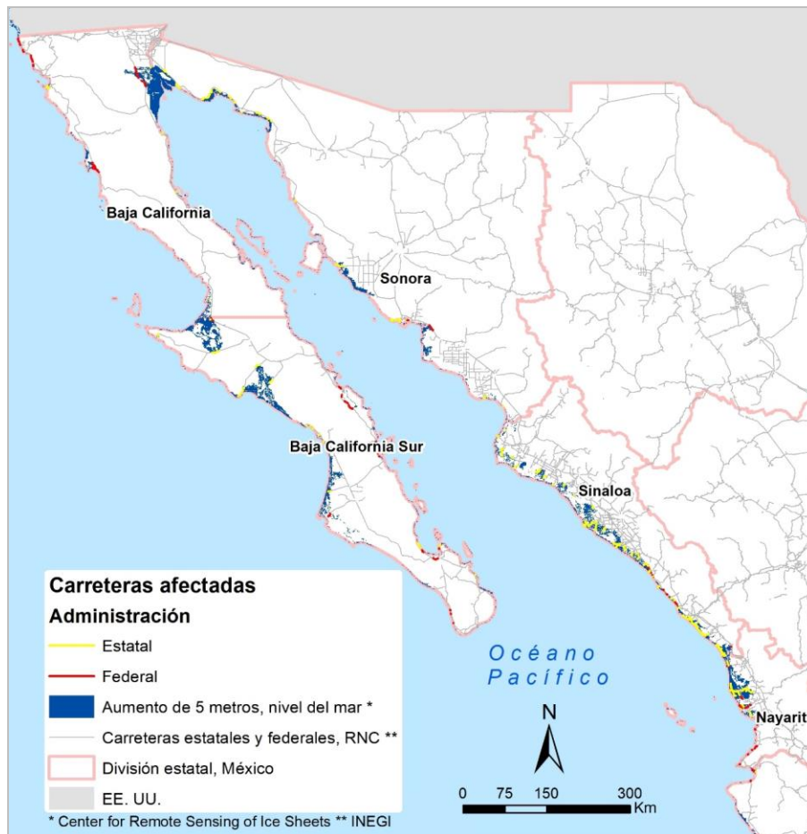
Figura 3.34 Escenario de aumento del nivel de mar de cinco metros en el Noroeste de México.
