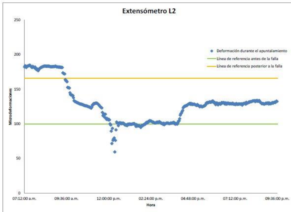
Figura 1.9 Deformaciones medidas por el sensor L2 durante la instalación del puntal
