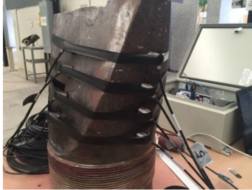
Figura 1.12 Prueba de emisiones acústicas según ASTM-F2174
