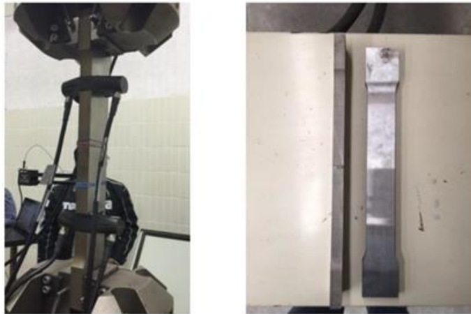
Figura 1.13 Prueba de tensión y probeta utilizada para simular condiciones de campo
