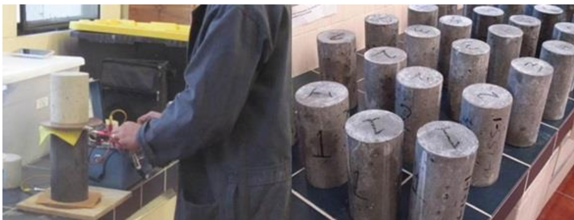
Figura 2.1 Medición de la REH en cilindros de concreto
