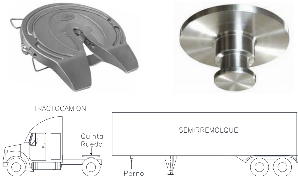
Figura 2.4 Mecanismo de enganche quinta rueda-perno rey
