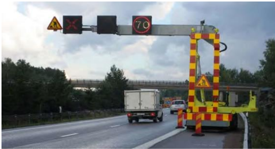
Figura 3.19 Grúa auxiliar para despliegue de señalización de obra.
