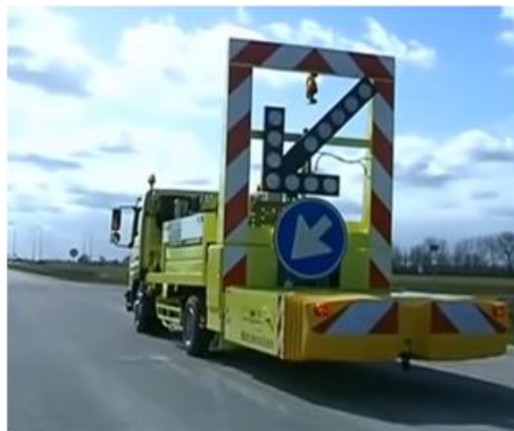
Figura 3.20 Camión auxiliar para despliegue de señalización de obra.
