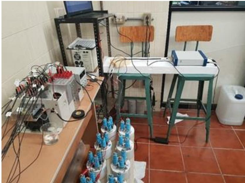
**Figura 2.2. Arreglo experimental para medir la velocidad de corrosión en varillas de refuerzo en solución poro y solución poro + 3.5% NaCl**
