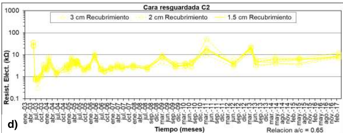
Figura B.2.3 Resistencia eléctrica vs. tiempo para: a) C1 Relación a/c: 0.45; b) C2 Relación a/c: 0.45; c) C1 Relación a/c: 0.45, y d) C2 Relación a/c: 0.65.
