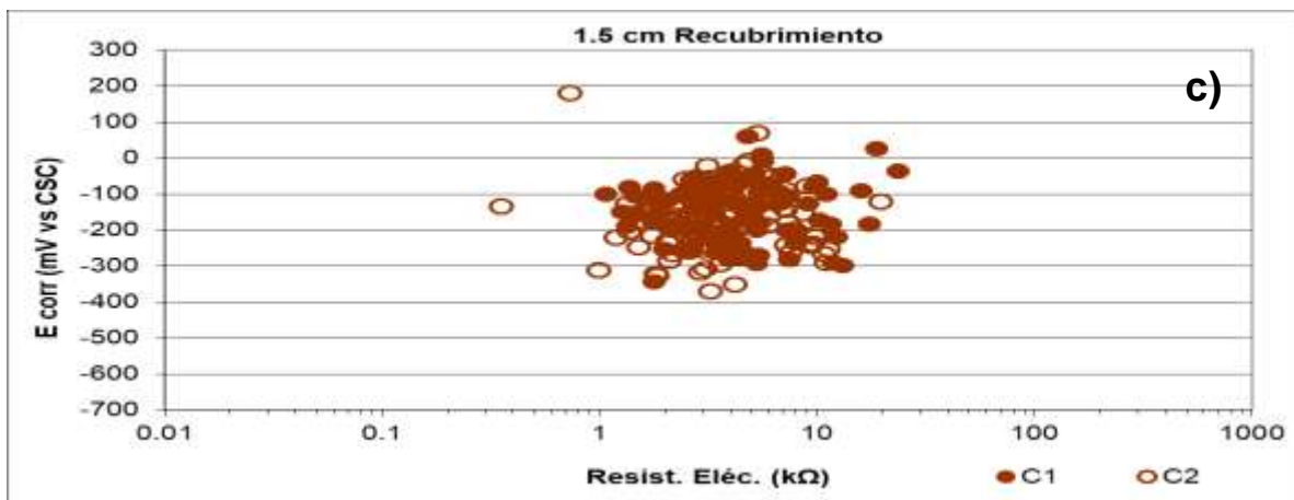
Figura E.4.3 Potencial de corrosión ( E_{corr} ) vs. resistencia eléctrica (Resist. Eléc.) 1.5 cm de recubrimiento: a) cara expuesta C1; b) cara resguardada C2, y c) C1 vs. C2.
