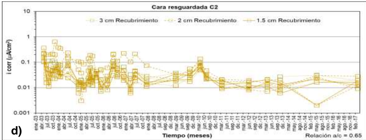
Figura B.7.1. Velocidad de corrosión (icorr) vs. tiempo para: a) C1 Relación a/c: 0.45; b) C2 Relación a/c: 0.45; c) C1 Relación a/c: 0.45, y d) C2 Relación a/c: 0.65
