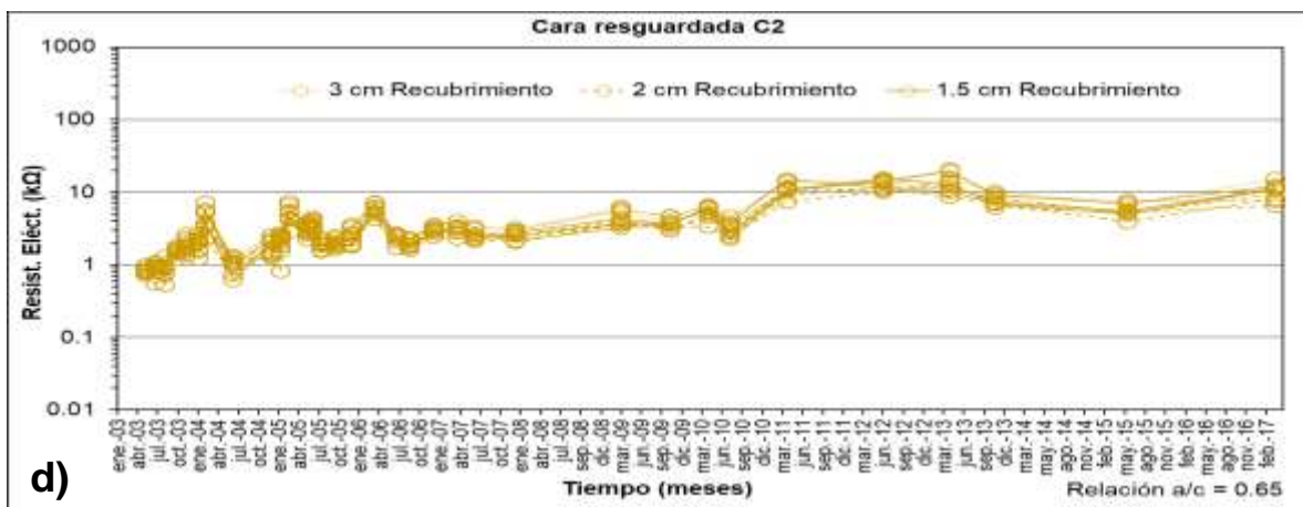
Figura B.7.3 Resistencia eléctrica vs. tiempo para: a) C1 Relación a/c: 0.45; b) C2 Relación a/c: 0.45; c) C1 Relación a/c: 0.45, y d) C2 Relación a/c: 0.65.
