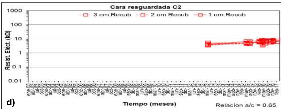
Figura B.8.3 Resistencia eléctrica vs. tiempo para: a) C1 Relación a/c: 0.45; b) C2 Relación a/c: 0.45; c) C1 Relación a/c: 0.45, y d) C2 Relación a/c: 0
