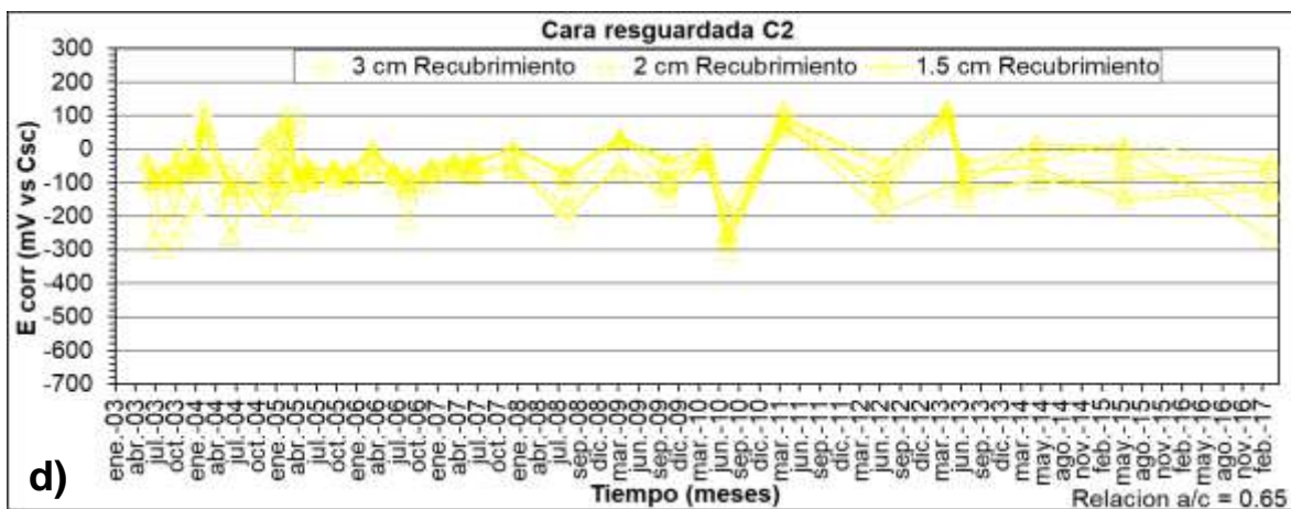
Figura B.2.2. Potencial de corrosión ( E_{corr} ) vs. tiempo para: a) C1 Relación a/c: 0.45; b) C2 Relación a/c: 0.45; c) C1 Relación a/c: 0.65, y d) C2 Relación a/c: 0.65
