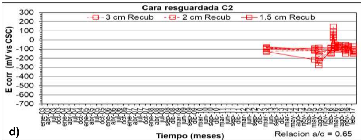
Figura B.8.2. Potencial de corrosión (Ecorr) vs. tiempo para: a) C1 Relación a/c: 0.45; b) C2 Relación a/c: 0.45; c) C1 Relación a/c: 0.45, y d) C2 Relación a/c: 0.65.
