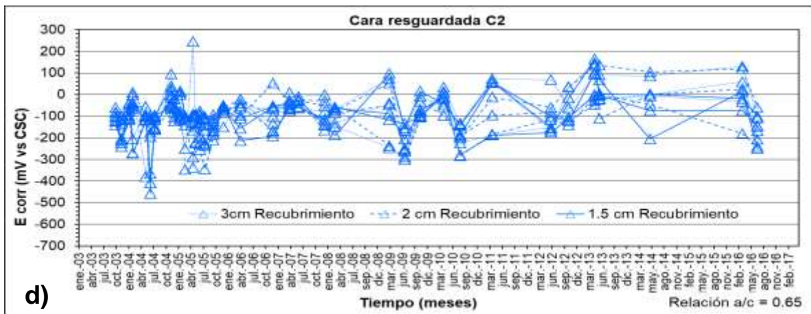
Figura B.3.2. Potencial de corrosión ( E_{corr} ) vs. tiempo para: a) C1 Relación a/c: 0.45; b) C2 Relación a/c: 0.45; c) C1 Relación a/c: 0.45, y d) C2 Relación a/c: 0.65
