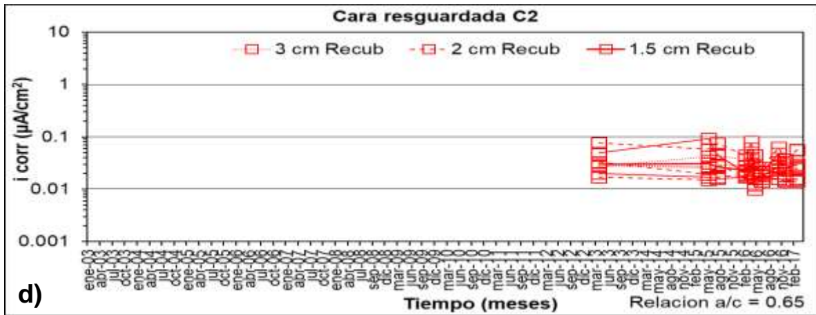
Figura B.8.1. Velocidad de corrosión ( i_{corr} ) vs. tiempo para: a) C1 Relación a/c: 0.45; b) C2 Relación a/c: 0.45; c) C1 Relación a/c: 0.45, y d) C2 Relación a/c: 0.65.
