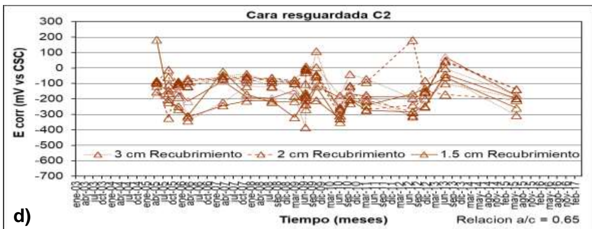
Figura B.4.2. Potencial de corrosión ( E_{corr} ) vs. tiempo para: a) C1 Relación a/c: 0.45; b) C2 Relación a/c: 0.45; c) C1 Relación a/c: 0.65, y d) C2 Relación a/c: 0.65
