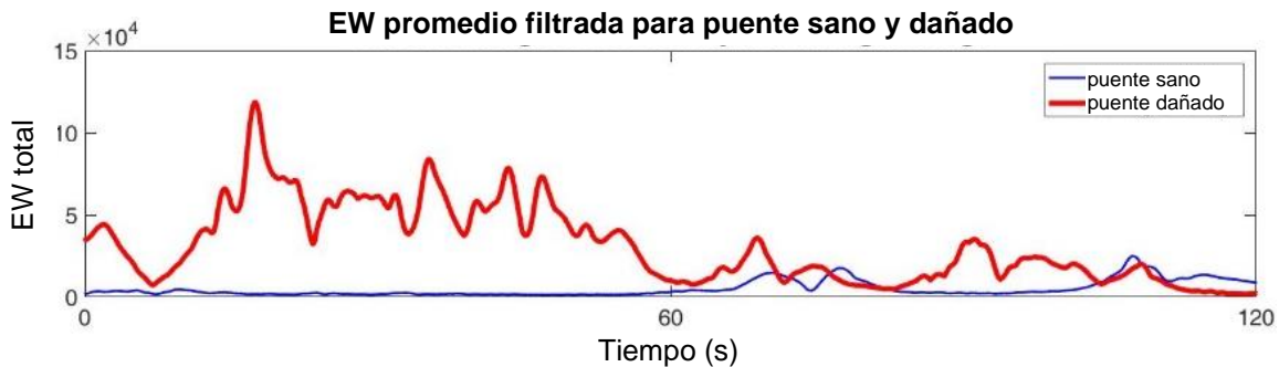
Figura 5.6. EW total promedio a partir de las señales experimentales filtradas para puente sano vs. puente con tirante dañado T1S5.
