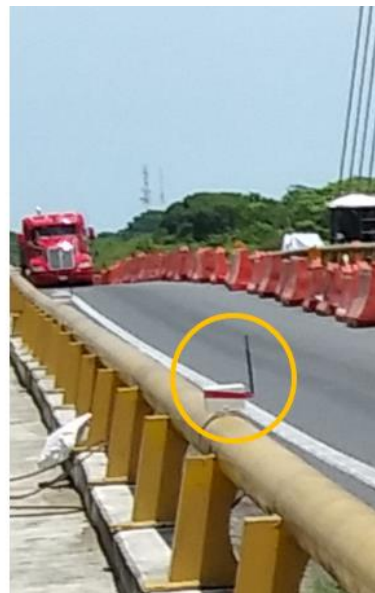
Figura 4.6. Acelerómetro colocado en el tablero del puente aguas arriba y adquiriendo datos con tráfico aleatorio.
