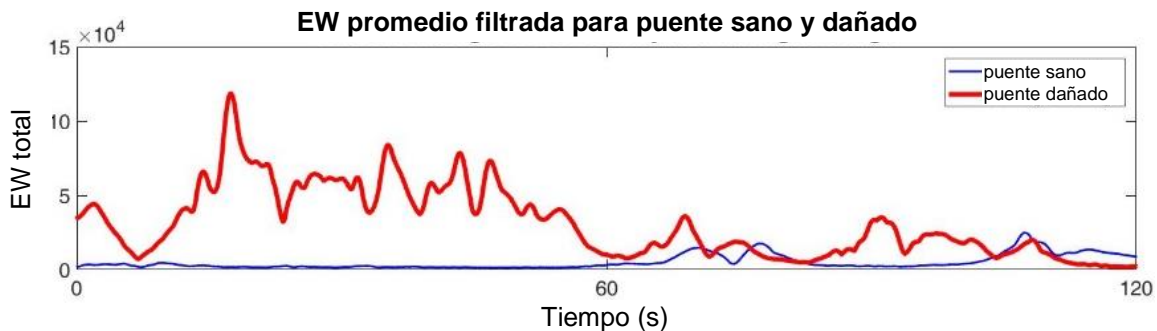
Figura 3.6. EW total promedio a partir de las señales experimentales filtradas para puente sano vs. puente con tirante dañado T1S5.
