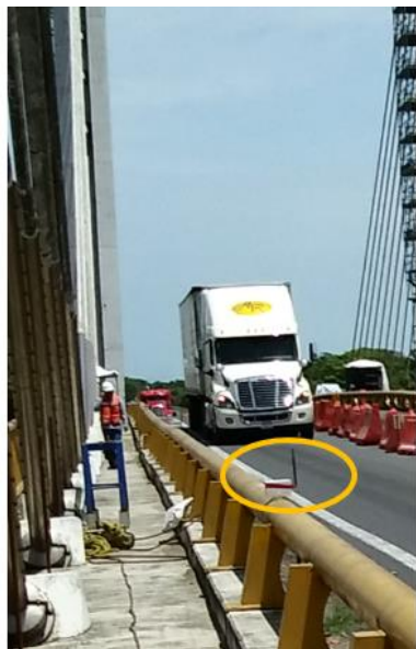
Figura 4.6. Acelerómetro colocado en el tablero del puente aguas arriba y adquiriendo datos con tráfico aleatorio.
