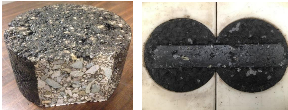
Figura 3.3 Corte de especímenes para ensayo RCH
