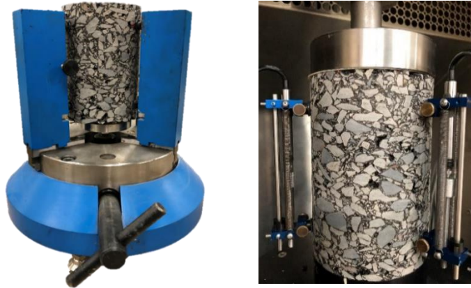
Figura 3.6 Instrumentación de los LVDT's
