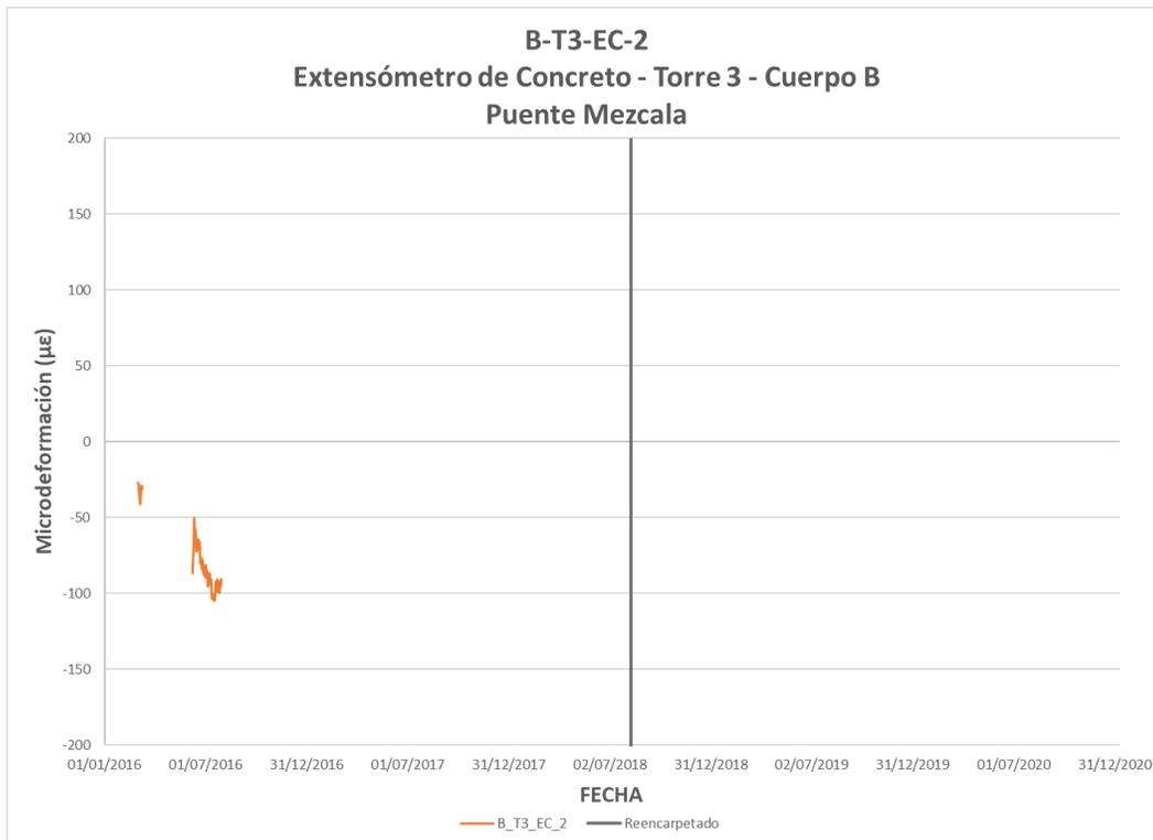
Figura 3.74 Valores de deformación del extensómetro B-T3-EC-2
