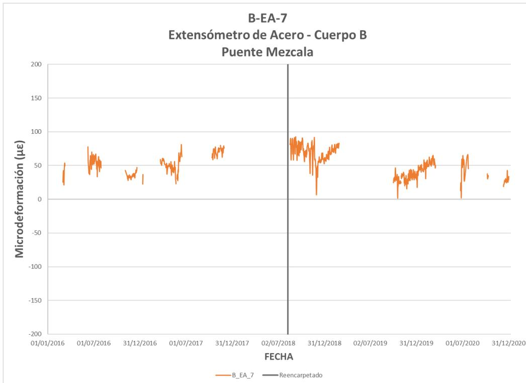
Figura 3.53 Valores de deformación del extensómetro B-EA-7
