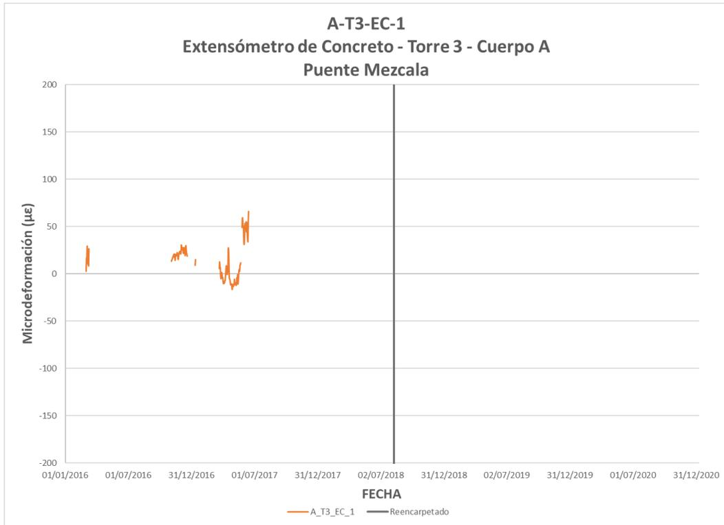
Figura 3.71 Valores de deformación del extensómetro A-T3-EC-1
