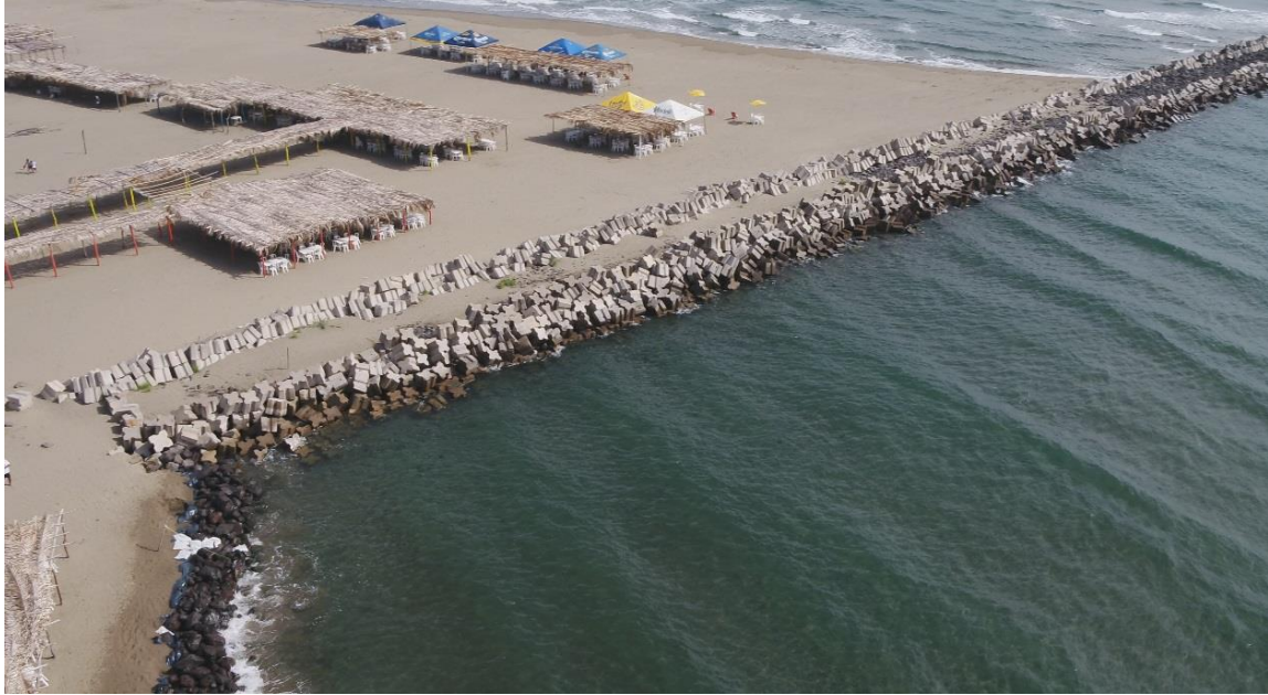
Figura 1.19 Imagen aérea tomada del VANT, donde se observa el azolve en playa en la parte “Oeste” de la zona de estudio, (segunda visita)
