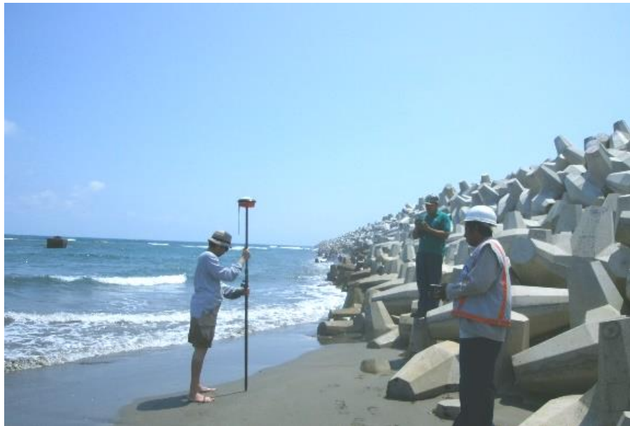
Figura 3.7 Traslado de cota de nivel con equipo GPS de alta precisión RTK del banco de nivel
