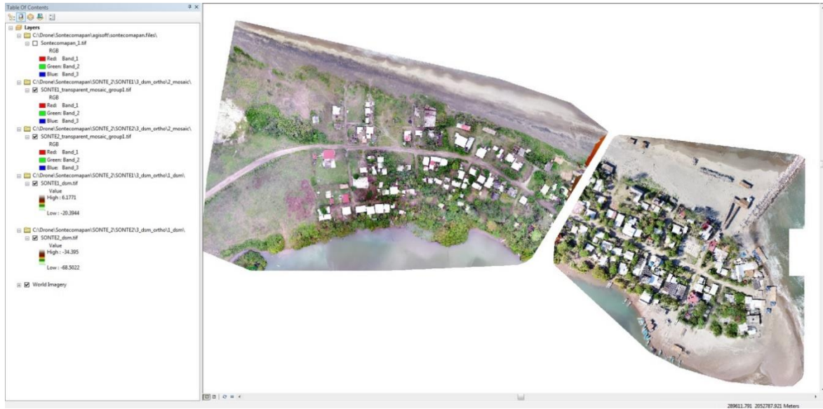
Figura 3.12 Orto mosaico geo-referenciado con puntos de control RTK (marzo 2017)
