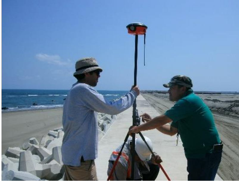
Figura 3.7 Traslado de cota de nivel con equipo GPS de alta precisión RTK del banco de nivel
