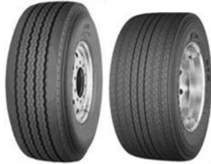
Figura 1.5 Comparativa de llantas de base ancha de primera (izq.) y segunda (der.) generación
