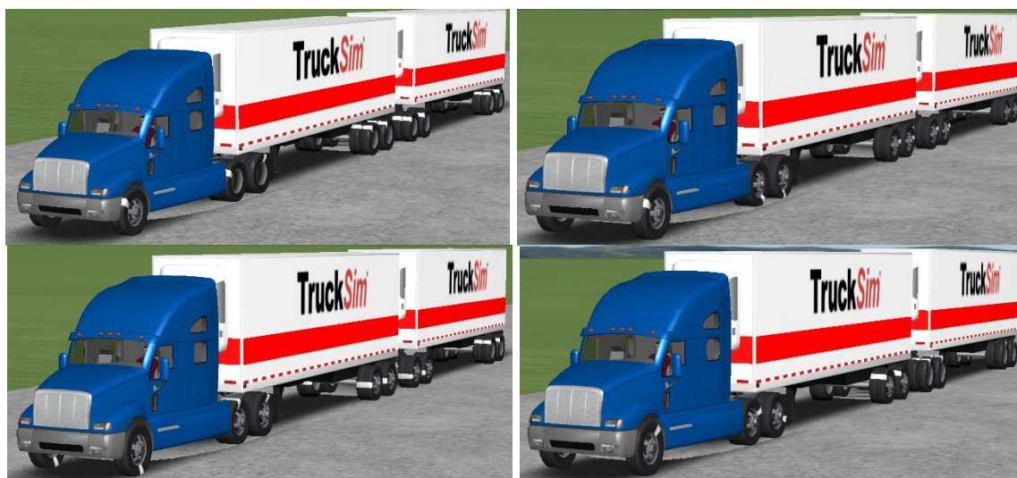
Figura 3.14 Representación visual de los casos de estudio R1, R2, C1 y C2 de configuración T3S2R4 en programa de simulación
