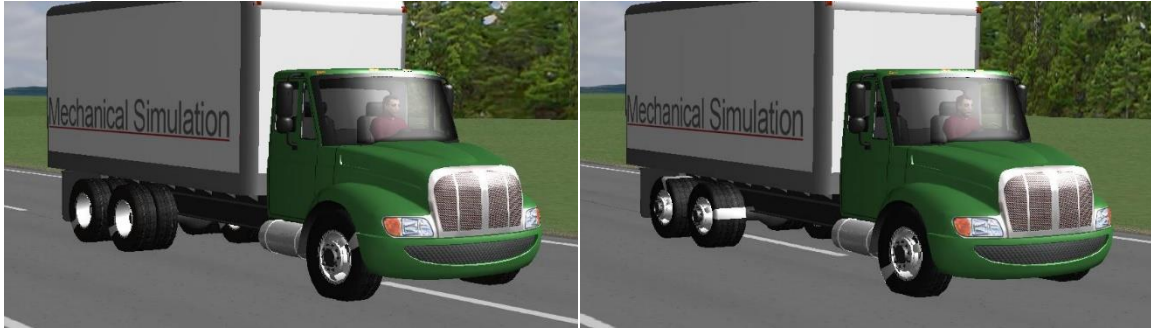
Figura 3.7 Representación visual de los casos de estudio R1 (arreglo dual) y R2 (base ancha) en programa de simulación
