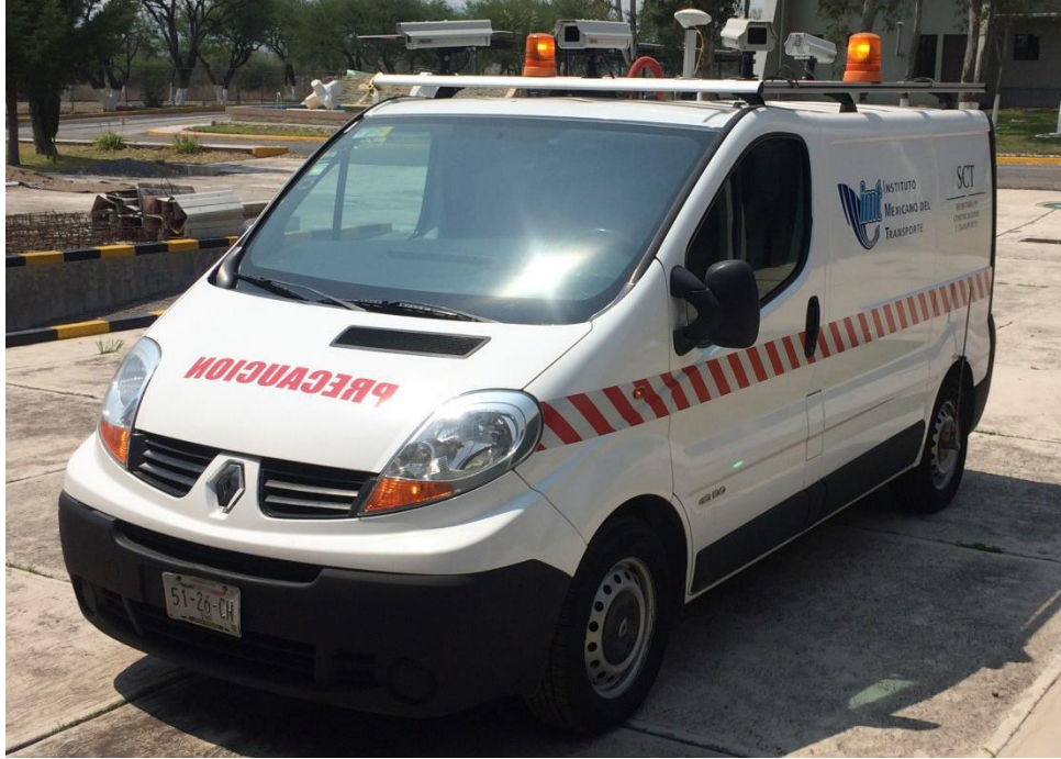
Figura 1.2 Vehículo de inspección Hawkeye 2000 del IMT
