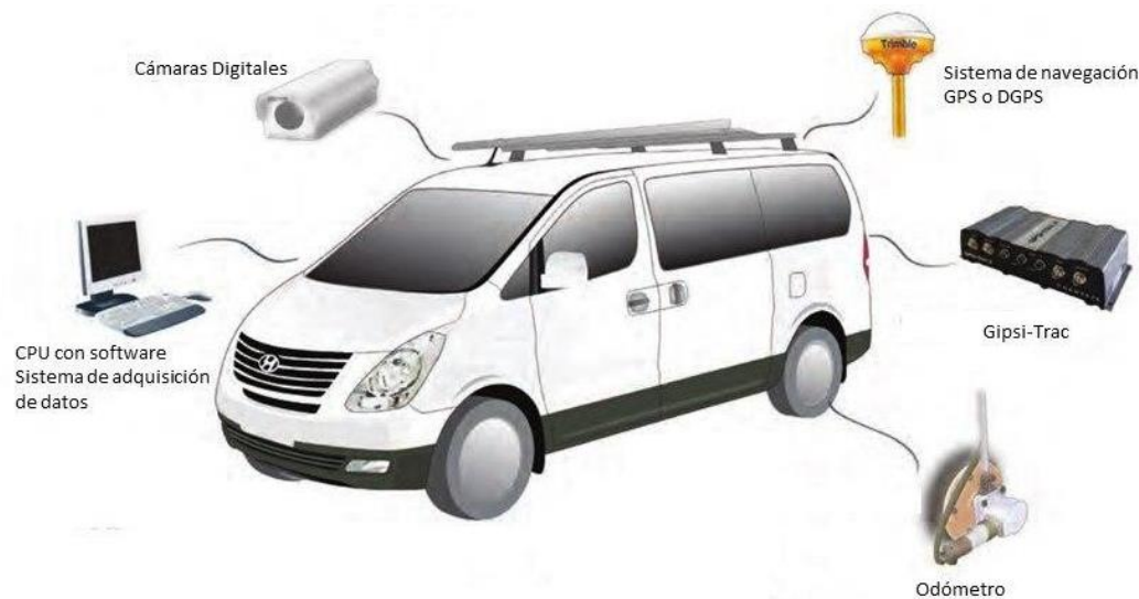
Figura I.1 Vehículo Hawkeye y sus componentes
