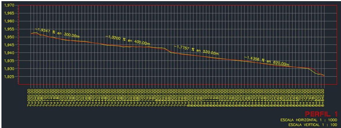
Figura 4.15 Perfil longitudinal en Civil CAD con pendientes en el tramo
