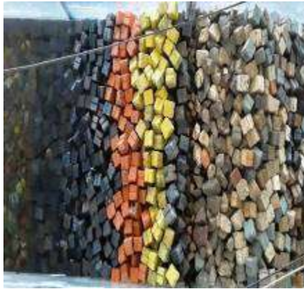
Figura 3. 77 Estructura antes de generar el tsunami de 3.44 m. de altura con N-Wave LE para el N.B.M.I. de la Sección Tipo del rompeolas de Cuyutlán, Col.
