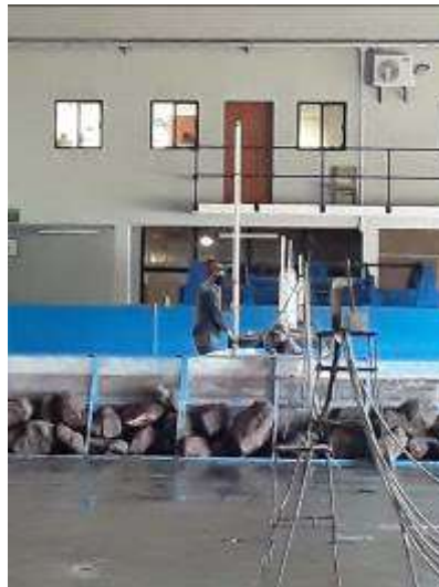
Figura 3. 7 Construcción de secciones a escala por construcción de pendiente de fondo (0.034, 0.044 y 0.054) del modelo hidráulico.
