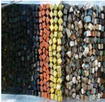
Figura 3. 27 Estructura antes de generar el tsunami de 2.58 m. de altura con N-Wave LE para el N.B.M.I. de la Sección Tipo del rompeolas de Cuyutlán, Col.
