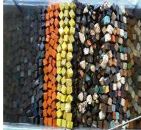
Figura 3. 38 Estructura después de generar el tsunami de 3.44 m. de altura con N-Wave LD para el N.B.M.I. de la Sección Tipo del rompeolas de Cuyutlán, Col.
