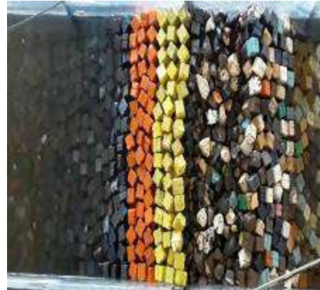
Figura 3. 54 Estructura después de generar el tsunami de 3.44 m. de altura con N-Wave LE para el N.B.M.I. de la Sección Tipo del rompeolas de Cuyutlán, Col.
