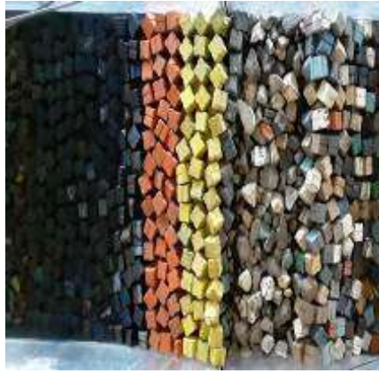
Figura 3. 37 Estructura antes de generar el tsunami de 3.44 m. de altura con N-Wave LD para el N.B.M.I. de la Sección Tipo del rompeolas de Cuyutlán, Col.
