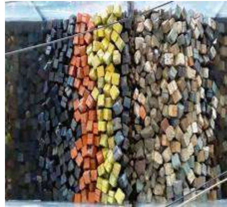
Figura 3. 66 Estructura después de generar el tsunami de 1.46 m. de altura con Onda Solitaria para el N.B.M.I. de la Sección Tipo del rompeolas de Cuyutlán, Col.
