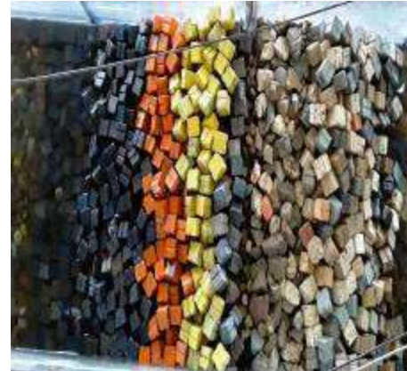
Figura 3. 84 Estructura después de generar el tsunami de 2.58 m. de altura con N-Wave LD para el N.B.M.I. de la Sección Tipo del rompeolas de Cuyutlán, Col.
