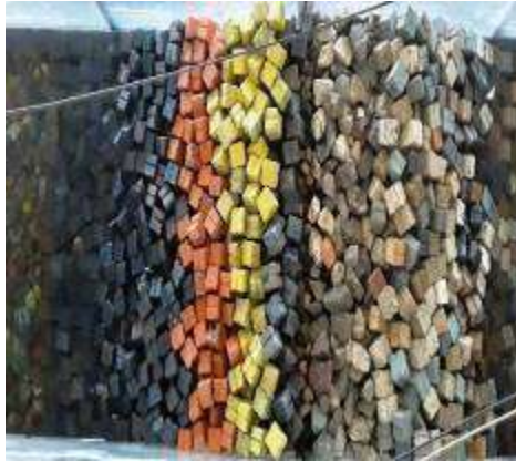
Figura 3. 85 Estructura antes de generar el tsunami de 3.44 m. de altura con N-Wave LD para el N.B.M.I. de la Sección Tipo del rompeolas de Cuyutlán, Col.
