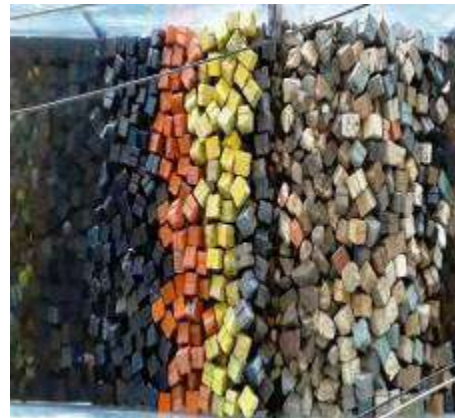
Figura 3. 68 Estructura después de generar el tsunami de 2.58 m. de altura con Onda Solitaria para el N.B.M.I. de la Sección Tipo del rompeolas de Cuyutlán, Col.
