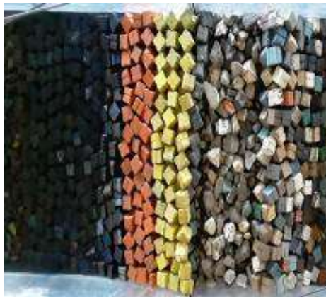
Figura 3. 15 Estructura antes de generar el tsunami de 1.08 m. de altura con Onda Solitaria para el N.B.M.I. de la Sección Tipo del rompeolas de Cuyutlán, Col.
