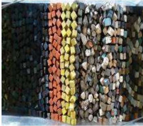
Figura 3. 57 Estructura antes de generar el tsunami de 1.46 m. de altura con N-Wave LD para el N.B.M.I. de la Sección Tipo del rompeolas de Cuyutlán, Col.
