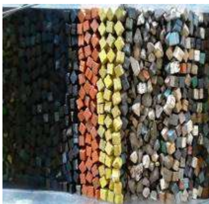
Figura 3. 51 Estructura antes de generar el tsunami de 2.58 m. de altura con N-Wave LE para el N.B.M.I. de la Sección Tipo del rompeolas de Cuyutlán, Col.
