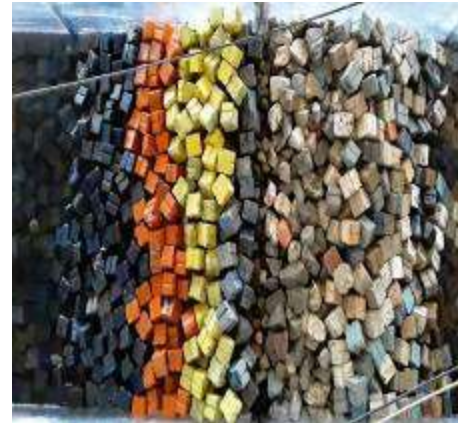
Figura 3. 78 Estructura después de generar el tsunami de 3.44 m. de altura con N-Wave LE para el N.B.M.I. de la Sección Tipo del rompeolas de Cuyutlán, Col.
