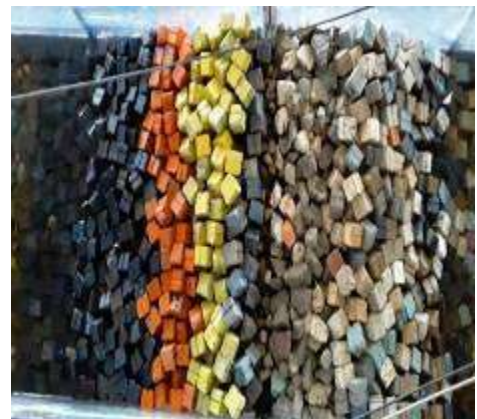
Figura 3. 80 Estructura después de generar el tsunami de 1.08 m. de altura con N-Wave LD para el N.B.M.I. de la Sección Tipo del rompeolas de Cuyutlán, Col.
