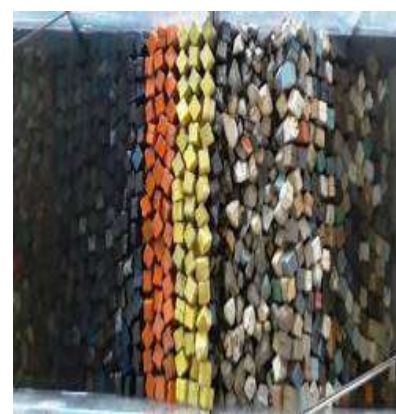
Figura 3. 24 Estructura después de generar el tsunami de 1.08 m. de altura con N-Wave LE para el N.B.M.I. de la Sección Tipo del rompeolas de Cuyutlán, Col.
