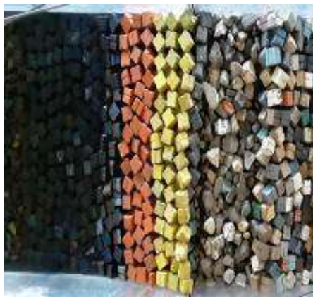
Figura 3. 23 Estructura antes de generar el tsunami de 1.08 m. de altura con N-Wave LE para el N.B.M.I. de la Sección Tipo del rompeolas de Cuyutlán, Col.
