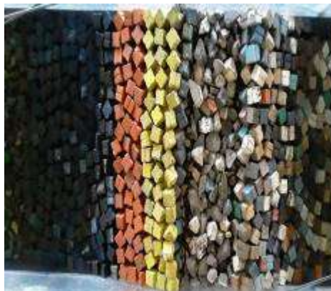
Figura 3. 39 Estructura antes de generar el tsunami de 1.08 m. de altura con Onda Solitaria para el N.B.M.I. de la Sección Tipo del rompeolas de Cuyutlán, Col.
