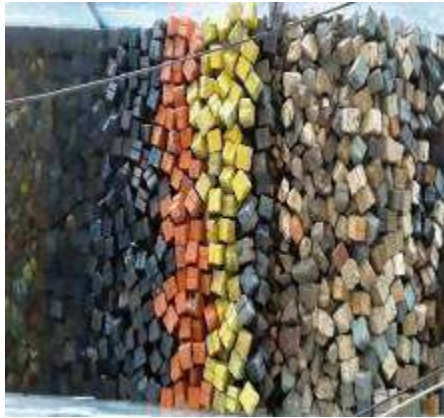
Figura 3. 65 Estructura antes de generar el tsunami de 1.46 m. de altura con Onda Solitaria para el N.B.M.I. de la Sección Tipo del rompeolas de Cuyutlán, Col.
