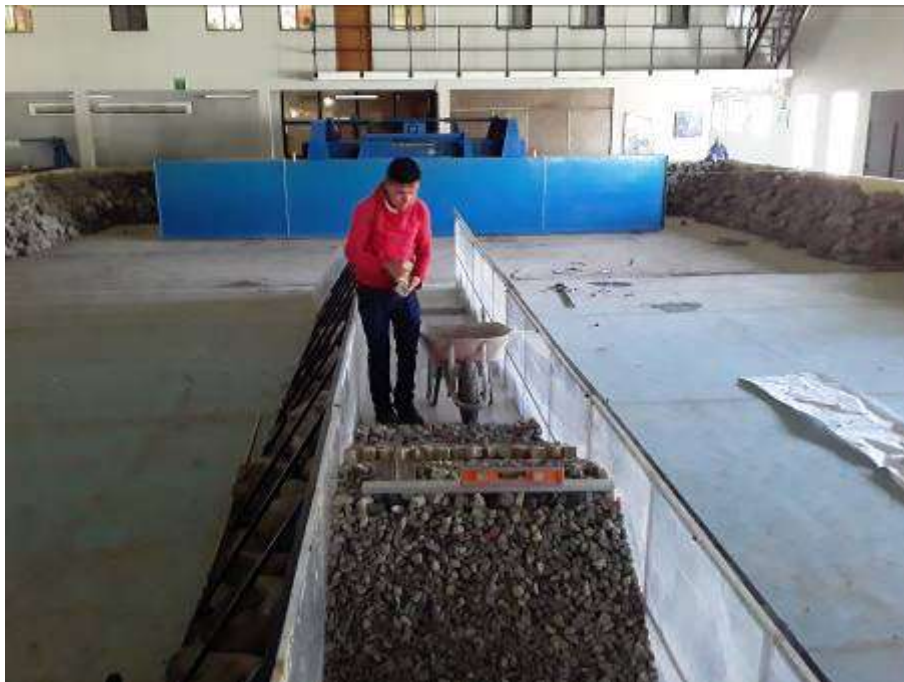
Figura 3. 5 Colocación y nivelación de elementos (cubos ranurados) para capa de coraza del rompeolas del modelo hidráulico.
