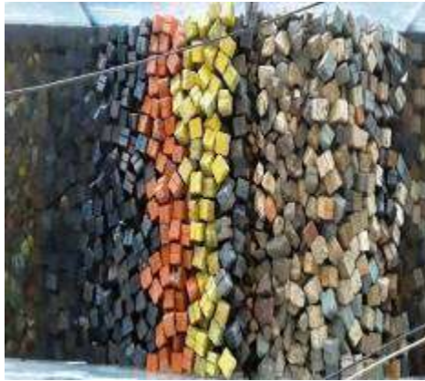
Figura 3. 81 Estructura antes de generar el tsunami de 1.46 m. de altura con N-Wave LD para el N.B.M.I. de la Sección Tipo del rompeolas de Cuyutlán, Col.
