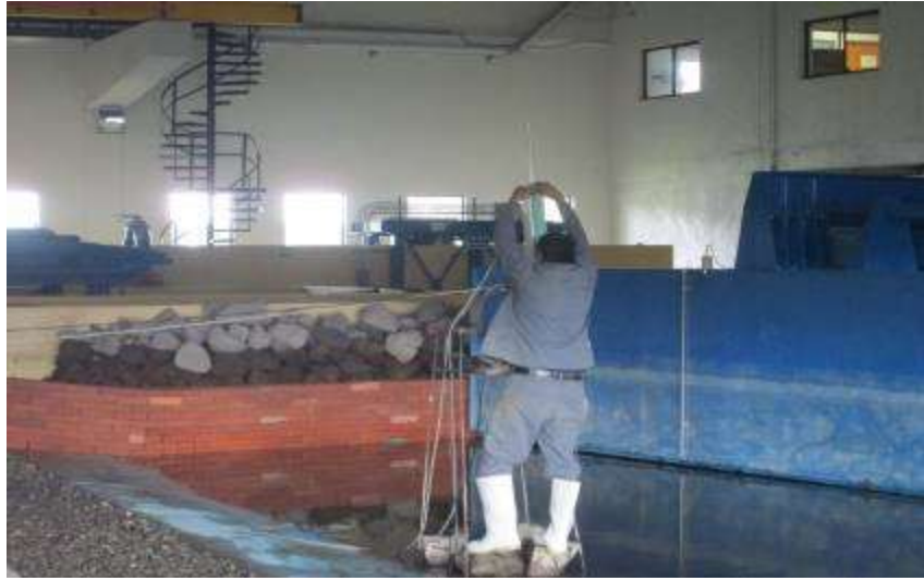
Figura 3. 6 Colocación de sensores tipo capacitivo en el modelo hidráulico.
