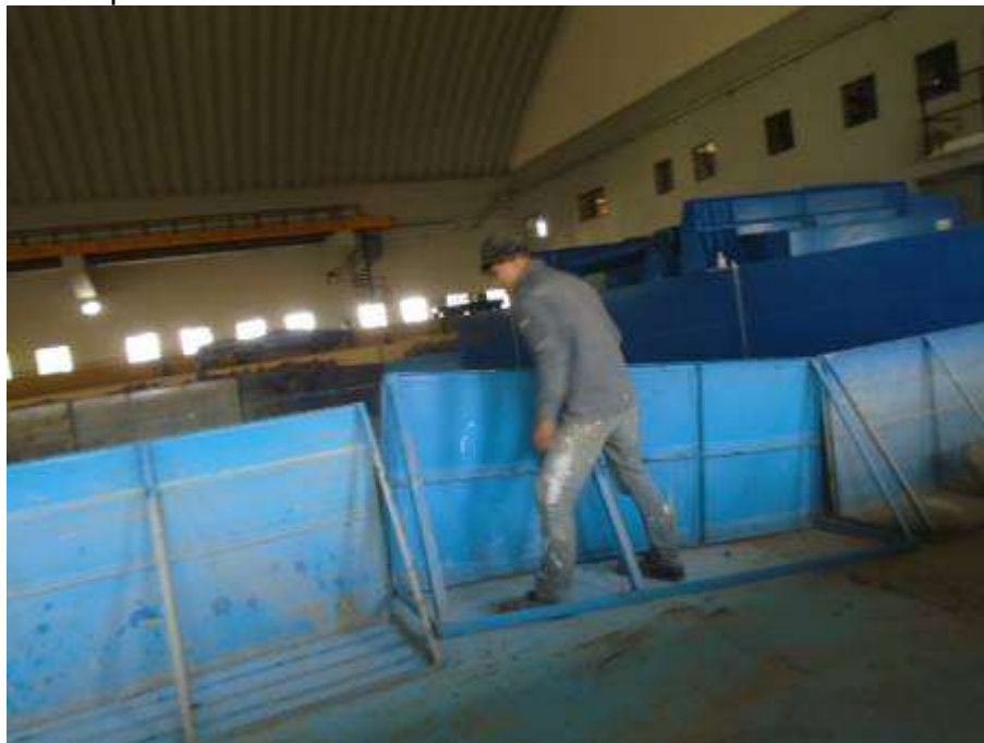
Figura 3. 3 Colocación de las ortogonales para la configuración del modelo hidráulico.
