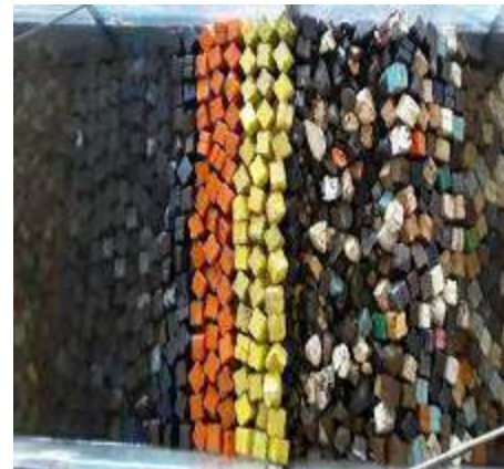
Figura 3.56 Estructura después de generar el tsunami de 1.08 m. de altura con N-Wave LD para el N.B.M.I. de la Sección Tipo del rompeolas de Cuyutlán, Col.
