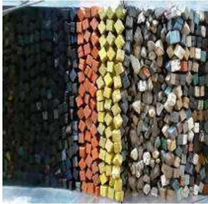
Figura 3. 25 Estructura antes de generar el tsunami de 1.46 m. de altura con N-Wave LE para el N.B.M.I. de la Sección Tipo del rompeolas de Cuyutlán, Col.
