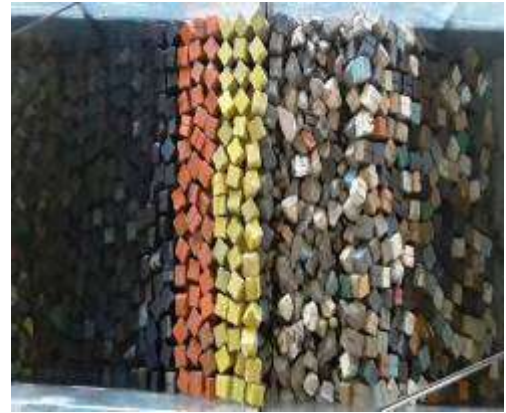
Figura 3. 42 Estructura después de generar el tsunami de 1.46 m. de altura con Onda Solitaria para el N.B.M.I. de la Sección Tipo del rompeolas de Cuyutlán, Col.
