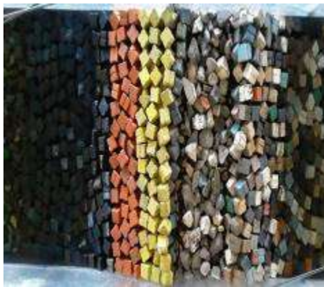
Figura 3. 59 Estructura antes de generar el tsunami de 2.58 m. de altura con N-Wave LD para el N.B.M.I. de la Sección Tipo del rompeolas de Cuyutlán, Col.
