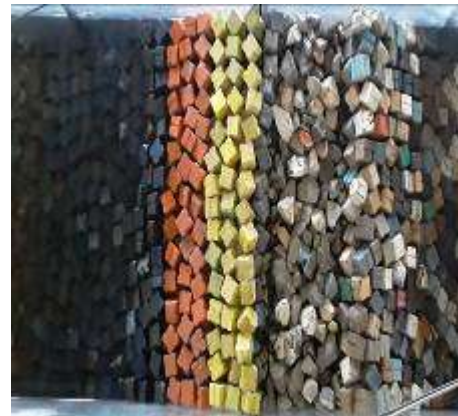
Figura 3. 20 Estructura después de generar el tsunami de 2.58 m. de altura con Onda Solitaria para el N.B.M.I. de la Sección Tipo del rompeolas de Cuyutlán, Col.
