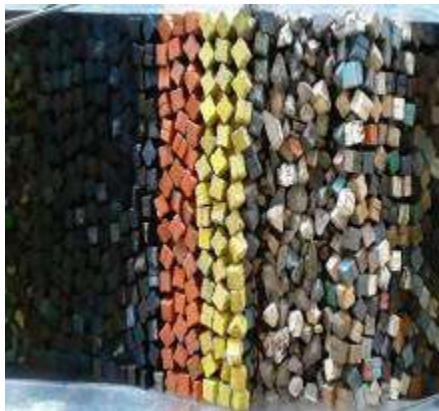
Figura 3. 47 Estructura antes de generar el tsunami de 1.08 m. de altura con N-Wave LE para el N.B.M.I. de la Sección Tipo del rompeolas de Cuyutlán, Col.
