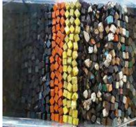
Figura 3. 52 Estructura después de generar el tsunami de 2.58 m. de altura con N-Wave LE para el N.B.M.I. de la Sección Tipo del rompeolas de Cuyutlán, Col.
