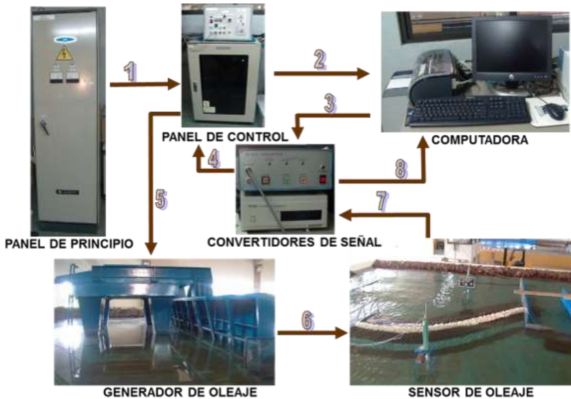
Figura 3. 8 Equipo utilizado para la generación, medición y análisis de oleaje.
