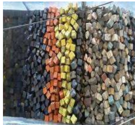
Figura 3. 64 Estructura después de generar el tsunami de 1.08 m. de altura con Onda Solitaria para el N.B.M.I. de la Sección Tipo del rompeolas de Cuyutlán, Col.
