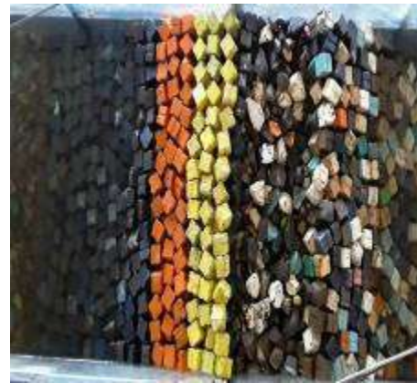
Figura 3. 32 Estructura después de generar el tsunami de 1.08 m. de altura con N-Wave LD para el N.B.M.I. de la Sección Tipo del rompeolas de Cuyutlán, Col.
