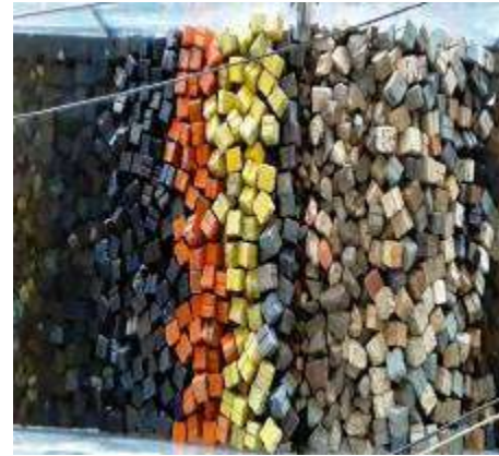
Figura 3. 82 Estructura después de generar el tsunami de 1.46 m. de altura con N-Wave LD para el N.B.M.I. de la Sección Tipo del rompeolas de Cuyutlán, Col.
