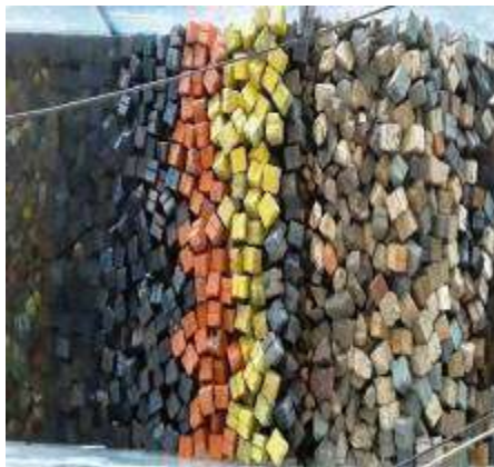
Figura 3. 63 Estructura antes de generar el tsunami de 1.08 m. de altura con Onda Solitaria para el N.B.M.I. de la Sección Tipo del rompeolas de Cuyutlán, Col.
