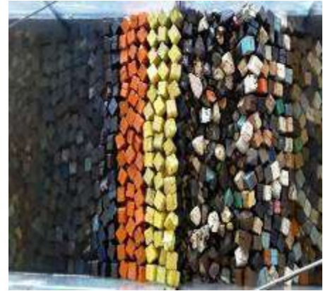
Figura 3. 58 Estructura después de generar el tsunami de 1.46 m. de altura con N-Wave LD para el N.B.M.I. de la Sección Tipo del rompeolas de Cuyutlán, Col.
