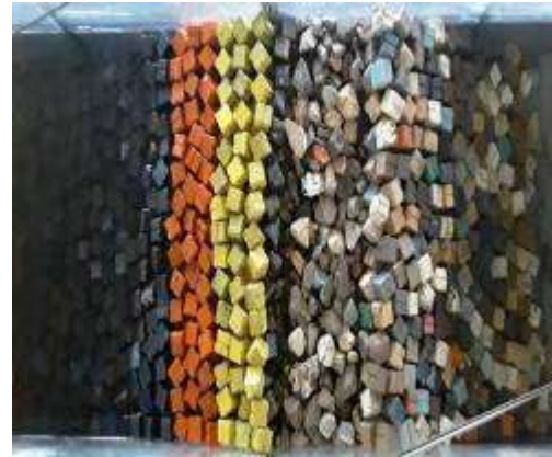
Figura 3. 46 Estructura después de generar el tsunami de 3.44 m. de altura con Onda Solitaria para el N.B.M.I. de la Sección Tipo del rompeolas de Cuyutlán, Col.
