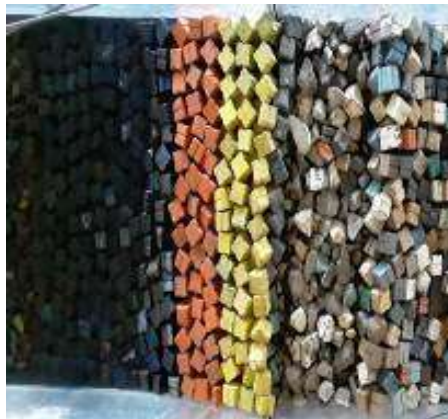
Figura 3. 31 Estructura antes de generar el tsunami de 1.08 m. de altura con N-Wave LD para el N.B.M.I. de la Sección Tipo del rompeolas de Cuyutlán, Col.
