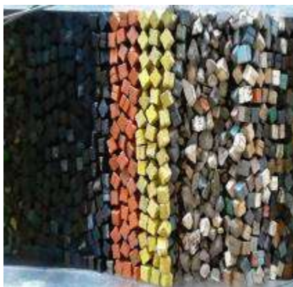
Figura 3. 49 Estructura antes de generar el tsunami de 1.46 m. de altura con N-Wave LE para el N.B.M.I. de la Sección Tipo del rompeolas de Cuyutlán, Col.
