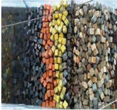
Figura 3. 69 Estructura antes de generar el tsunami de 3.44 m. de altura con Onda Solitaria para el N.B.M.I. de la Sección Tipo del rompeolas de Cuyutlán, Col.
