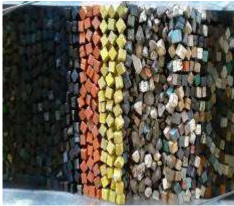
Figura 3. 61 Estructura antes de generar el tsunami de 3.44 m. de altura con N-Wave LD para el N.B.M.I. de la Sección Tipo del rompeolas de Cuyutlán, Col.
