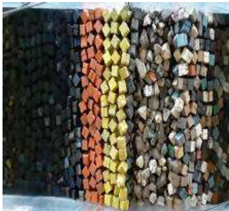
Figura 3. 19 Estructura antes de generar el tsunami de 2.58 m. de altura con Onda Solitaria para el N.B.M.I. de la Sección Tipo del rompeolas de Cuyutlán, Col.
