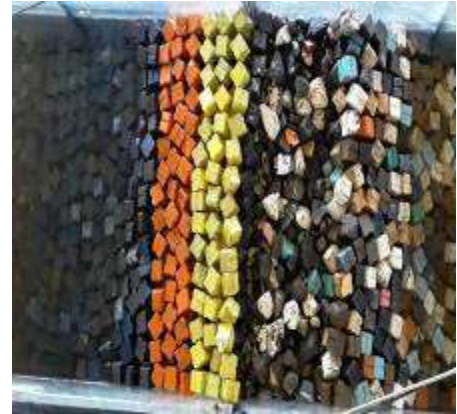
Figura 3. 60 Estructura después de generar el tsunami de 2.58 m. de altura con N-Wave LD para el N.B.M.I. de la Sección Tipo del rompeolas de Cuyutlán, Col.
