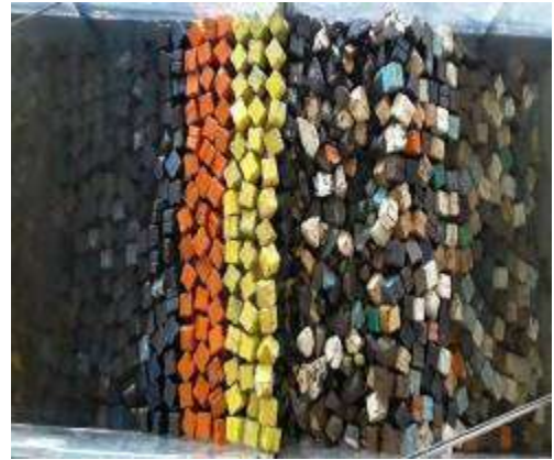
Figura 3. 30 Estructura después de generar el tsunami de 3.44 m. de altura con N-Wave LE para el N.B.M.I. de la Sección Tipo del rompeolas de Cuyutlán, Col.
