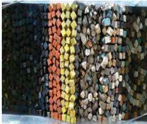
Figura 3. 45 Estructura antes de generar el tsunami de 3.44 m. de altura con Onda Solitaria para el N.B.M.I. de la Sección Tipo del rompeolas de Cuyutlán, Col.
