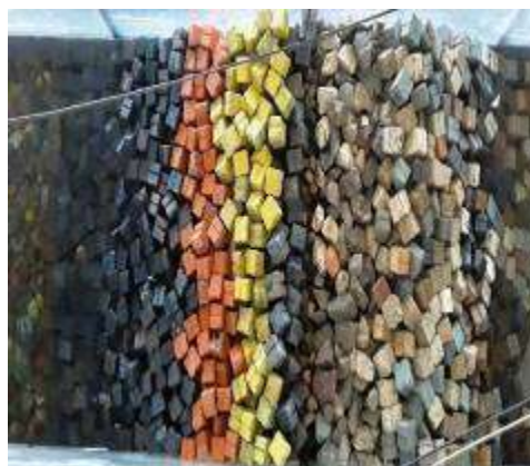
Figura 3. 71 Estructura antes de generar el tsunami de 1.08 m. de altura con N-Wave LE para el N.B.M.I. de la Sección Tipo del rompeolas de Cuyutlán, Col.
