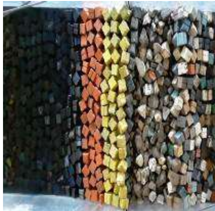
Figura 3. 33 Estructura antes de generar el tsunami de 1.46 m. de altura con N-Wave LD para el N.B.M.I. de la Sección Tipo del rompeolas de Cuyutlán, Col.
