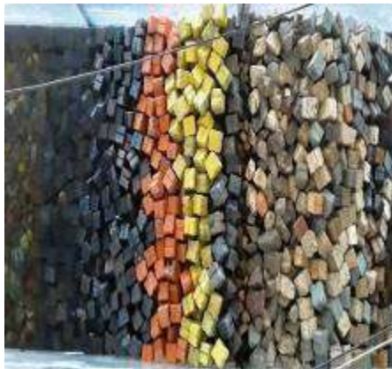
Figura 3. 67 Estructura antes de generar el tsunami de 2.58 m. de altura con Onda Solitaria para el N.B.M.I. de la Sección Tipo del rompeolas de Cuyutlán, Col.
