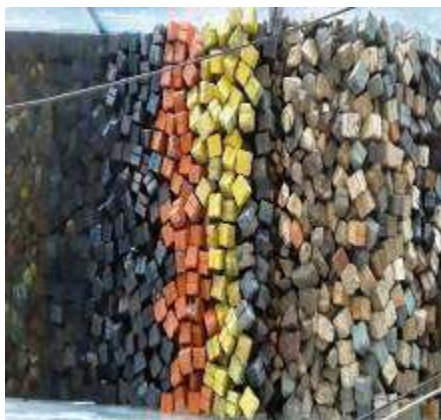
Figura 3. 75 Estructura antes de generar el tsunami de 2.58 m. de altura con N-Wave LE para el N.B.M.I. de la Sección Tipo del rompeolas de Cuyutlán, Col.
