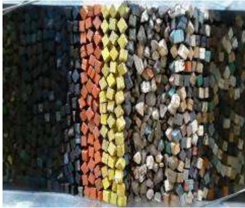
Figura 3. 41 Estructura antes de generar el tsunami de 1.46 m. de altura con Onda Solitaria para el N.B.M.I. de la Sección Tipo del rompeolas de Cuyutlán, Col.
