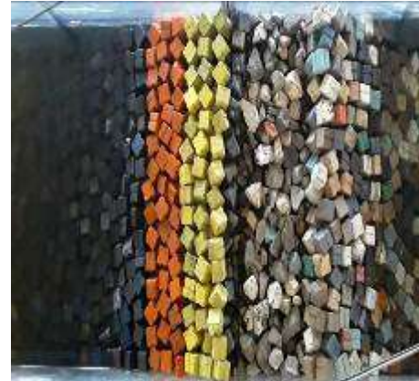
Figura 3. 22 Estructura después de generar el tsunami de 3.44 m. de altura con Onda Solitaria para el N.B.M.I. de la Sección Tipo del rompeolas de Cuyutlán, Col.
