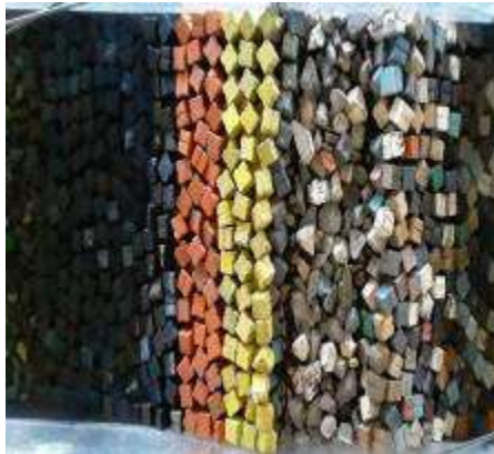
Figura 3.55 Estructura antes de generar el tsunami de 1.08 m. de altura con N-Wave LD para el N.B.M.I. de la Sección Tipo del rompeolas de Cuyutlán, Col.
