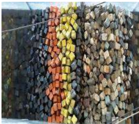
Figura 3. 83 Estructura antes de generar el tsunami de 2.58 m. de altura con N-Wave LD para el N.B.M.I. de la Sección Tipo del rompeolas de Cuyutlán, Col.
