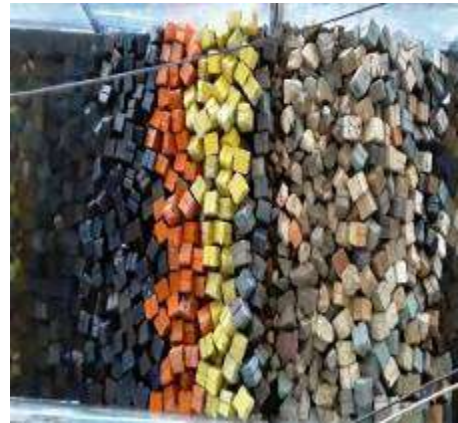
Figura 3. 74 Estructura después de generar el tsunami de 1.46 m. de altura con N-Wave LE para el N.B.M.I. de la Sección Tipo del rompeolas de Cuyutlán, Col.
