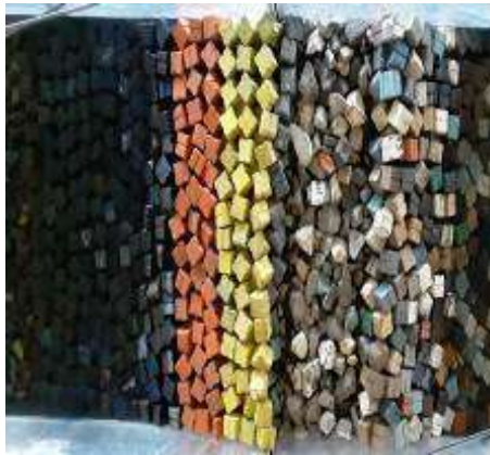
Figura 3. 17 Estructura antes de generar el tsunami de 1.46 m. de altura con Onda Solitaria para el N.B.M.I. de la Sección Tipo del rompeolas de Cuyutlán, Col.
