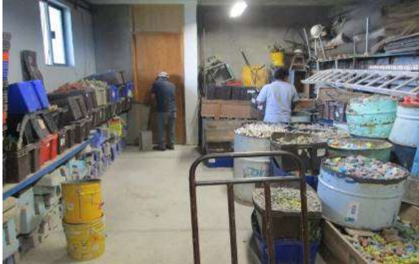
Figura 3. 2 Selección del material (granzón, grava y cubos ranurados) para la formación de las capas de la sección del modelo hidráulico.
