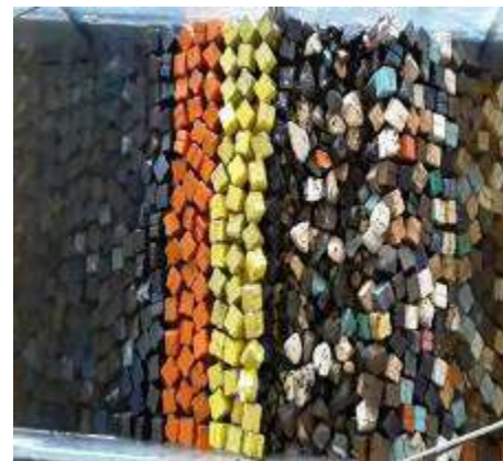
Figura 3. 36 Estructura después de generar el tsunami de 2.58 m. de altura con N-Wave LD para el N.B.M.I. de la Sección Tipo del rompeolas de Cuyutlán, Col.
