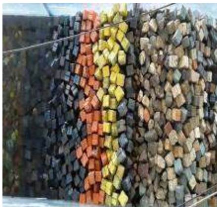
Figura 3. 79 Estructura antes de generar el tsunami de 1.08 m. de altura con N-Wave LD para el N.B.M.I. de la Sección Tipo del rompeolas de Cuyutlán, Col.
