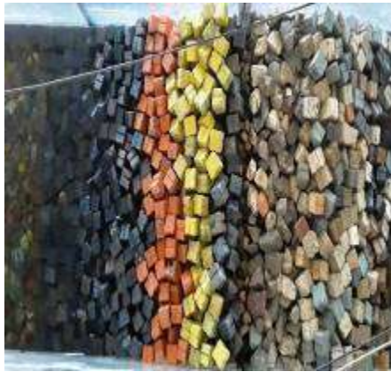
Figura 3. 73 Estructura antes de generar el tsunami de 1.46 m. de altura con N-Wave LE para el N.B.M.I. de la Sección Tipo del rompeolas de Cuyutlán, Col.
