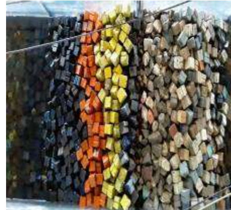
Figura 3. 86 Estructura después de generar el tsunami de 3.44 m. de altura con N-Wave LD para el N.B.M.I. de la Sección Tipo del rompeolas de Cuyutlán, Col.
