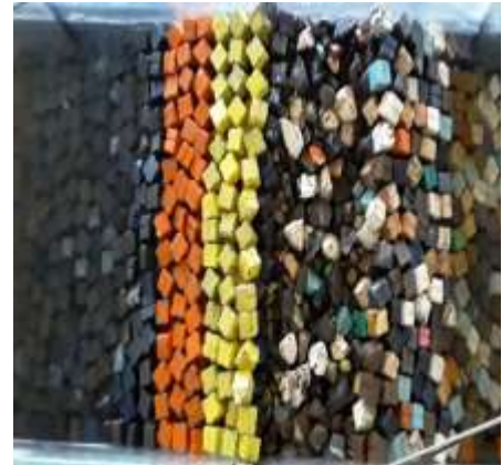
Figura 3. 62 Estructura después de generar el tsunami de 3.44 m. de altura con N-Wave LD para el N.B.M.I. de la Sección Tipo del rompeolas de Cuyutlán, Col.
