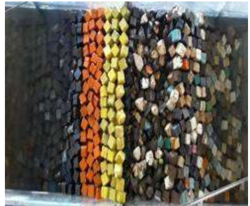
Figura 3. 28 Estructura después de generar el tsunami de 2.58 m. de altura con N-Wave LE para el N.B.M.I. de la Sección Tipo del rompeolas de Cuyutlán, Col.
