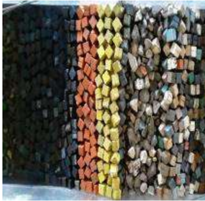
Figura 3. 53 Estructura antes de generar el tsunami de 3.44 m. de altura con N-Wave LE para el N.B.M.I. de la Sección Tipo del rompeolas de Cuyutlán, Col.
