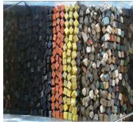
Figura 3. 18 Estructura después de generar el tsunami de 1.46 m. de altura con Onda Solitaria para el N.B.M.I. de la Sección Tipo del rompeolas de Cuyutlán, Col.
