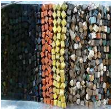
Figura 3. 29 Estructura antes de generar el tsunami de 3.44 m. de altura con N-Wave LE para el N.B.M.I. de la Sección Tipo del rompeolas de Cuyutlán, Col.
