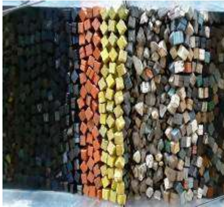
Figura 3. 21 Estructura antes de generar el tsunami de 3.44 m. de altura con Onda Solitaria para el N.B.M.I. de la Sección Tipo del rompeolas de Cuyutlán, Col.
