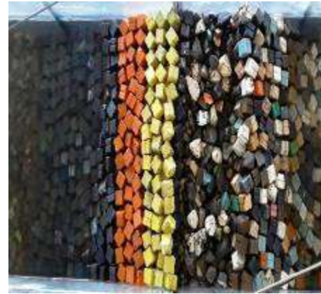
Figura 3. 34 Estructura después de generar el tsunami de 1.46 m. de altura con N-Wave LD para el N.B.M.I. de la Sección Tipo del rompeolas de Cuyutlán, Col.
