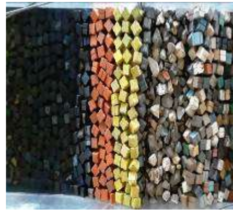
Figura 3. 16 Estructura después de generar el tsunami de 1.08 m. de altura con Onda Solitaria para el N.B.M.I. de la Sección Tipo del rompeolas de Cuyutlán, Col.
