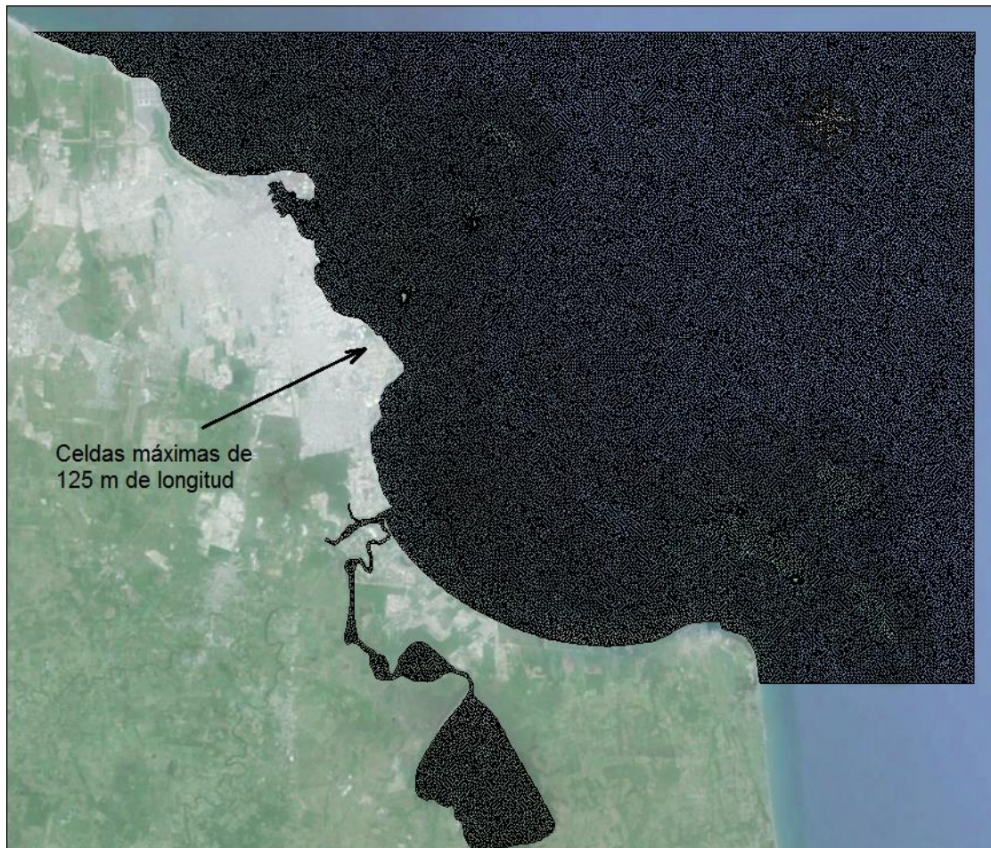
Figura 2.1 Primera malla de cálculo con celdas máximas de 125 m de longitud
