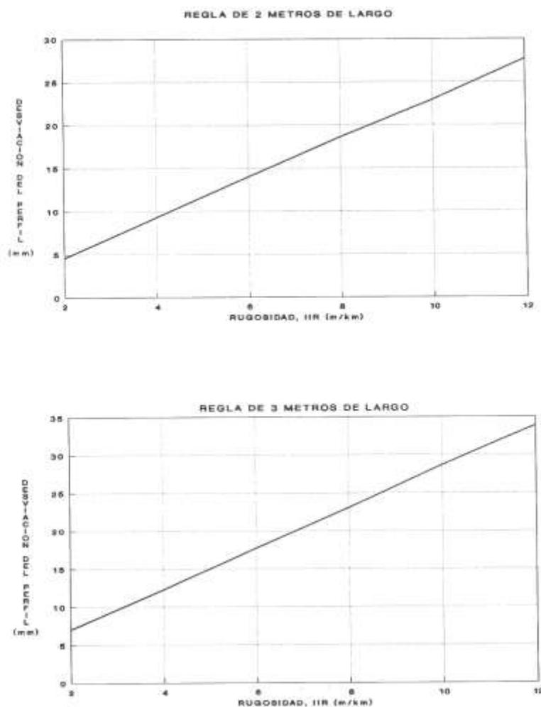
Nota: Las desviaciones del perfil corresponden al valor del 95 percentil de las mediciones, bajo la regla correspondiente.
