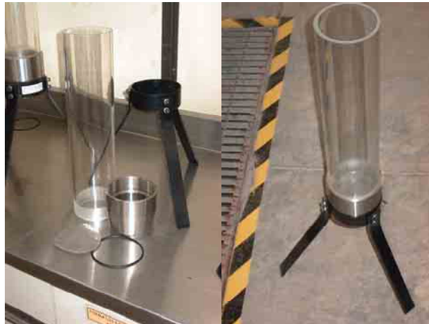
Figura 3.17 Permeámetro de carga variable. Se muestra en piezas y armado.
