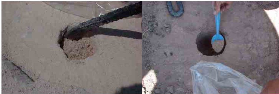
Figura 3.9 Excavación y recuperación del material del sondeo.
