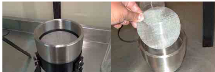
Figura 3.18 Casco de acero inoxidable y malla No. 100.
