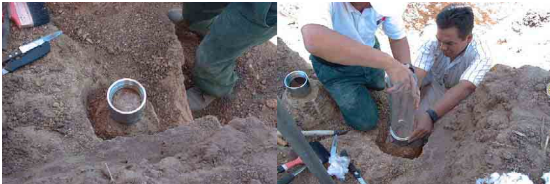
Figura 3.23 Colocación del equipo extractor sobre el suelo.
