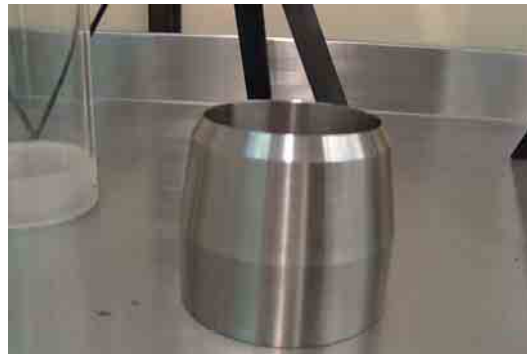
Figura 3.19 Detalle del filo del casco de acero inoxidable, auxiliar en la extracción de la muestra.
