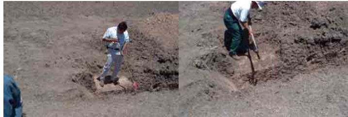
Figura 3.21 Preparación del sitio para extracción de la muestra inalterada.
