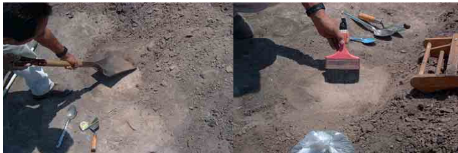
Figura 3.8 Nivelación y limpieza del sitio de prueba.
