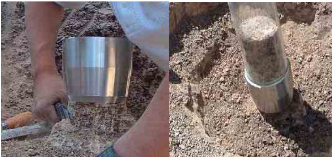
Figura 3.24 Se muestra la colocación del extractor y el suelo inalterado dentro del equipo.
