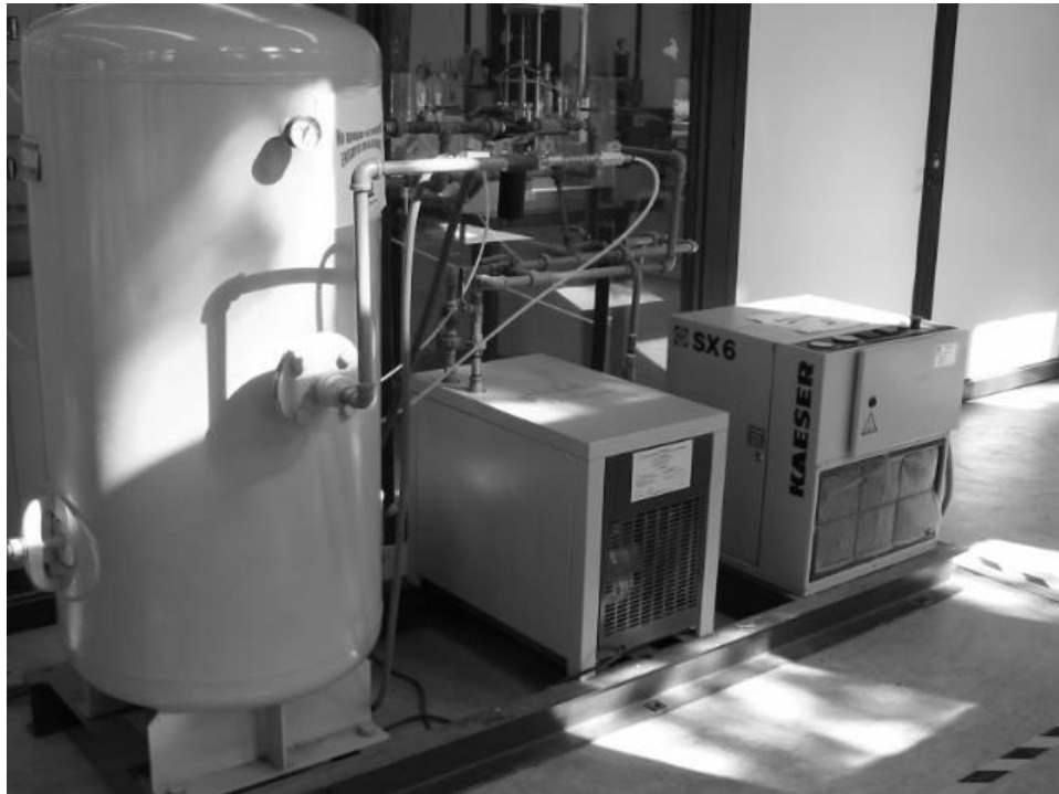
Figura 3.1 Compresor de aire con sistema de refrigeración para suministro de aire seco (IMT)
