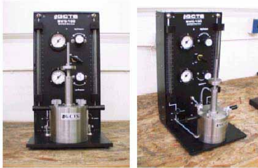
Figura 3.7 Edómetros con control de succión, panel de presión y medidores de cambio de volumen de agua
