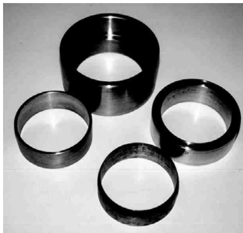
FIGURA 3.24 Anillos edométricos biselados para la obtención de las probetas
