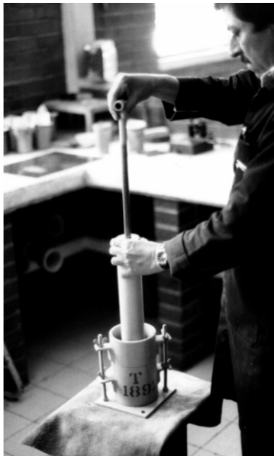
FIGURA 3.21 Elaboración del espécimen de prueba
