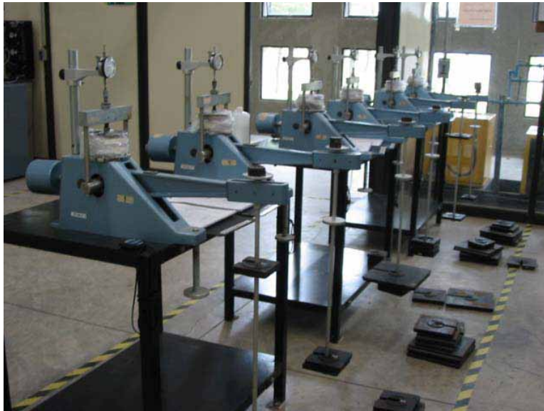
Figura 3.5 Edómetros convencionales, Laboratorios de Infraestructura Instituto Mexicano del Transporte
