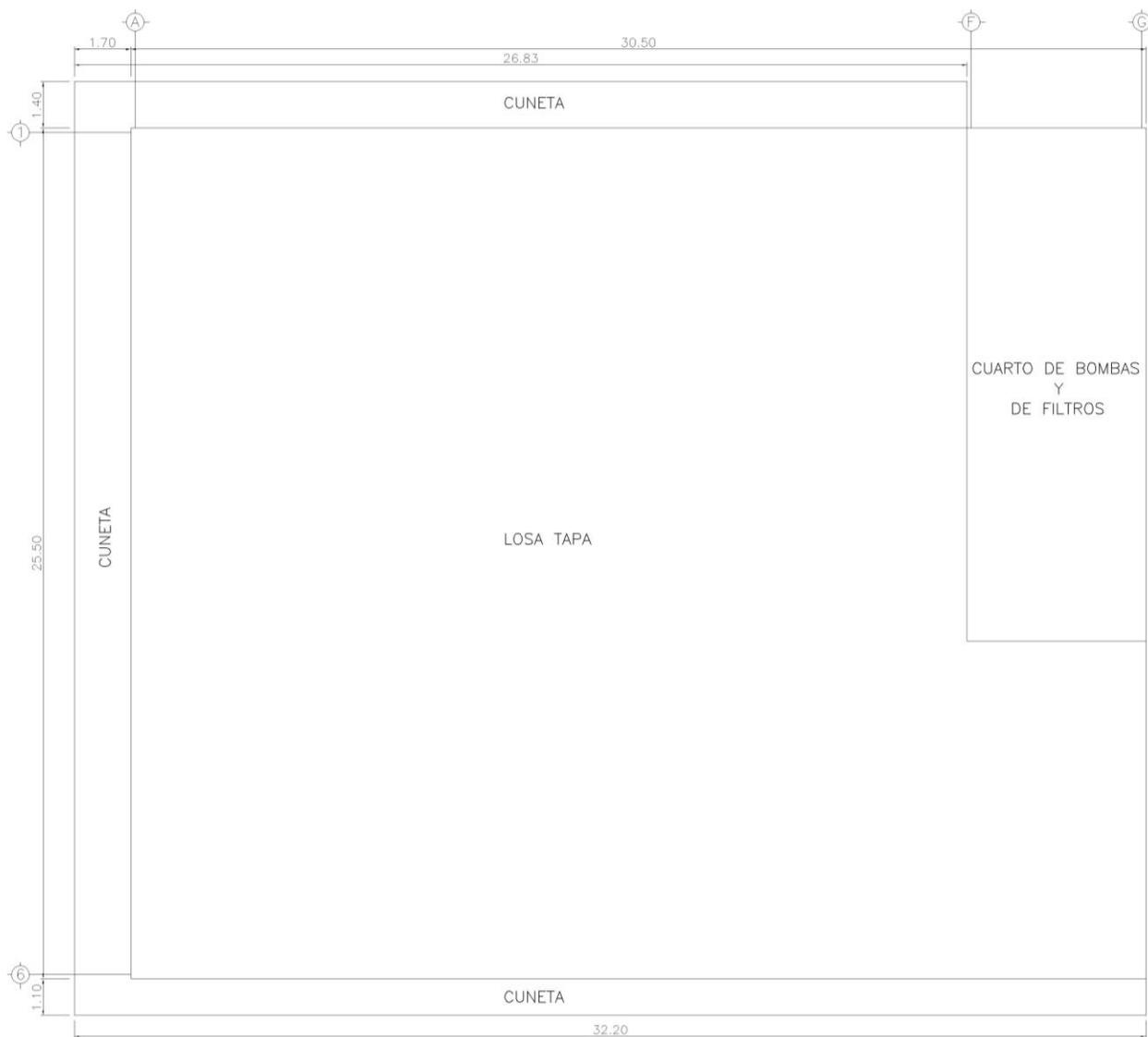
PLANTA GENERAL CISTERNA LOSA TAPA, CUARTO DE BOMBAS Y CUNETAS
