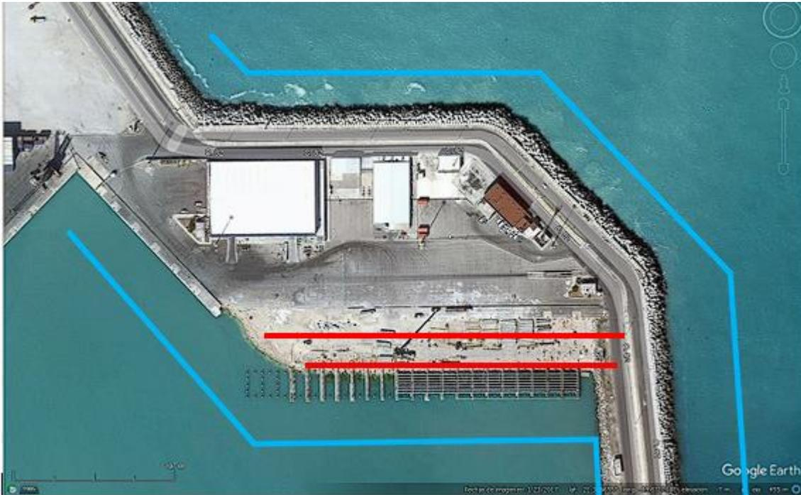
**Figura.1. Las líneas azules en el mar y las rojas en tierra, indican las longitudes de las tomografías sísmicas y eléctrica.**
